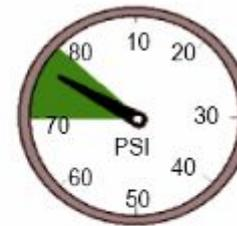
Маркировка параметров на шкале прибора
