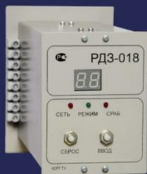
Предназначена для отключения комплектных распределительных устройств (КРУ) при возникновении сопровождающихся открытой электрической дугой коротких замыканий внутри отсеков.
