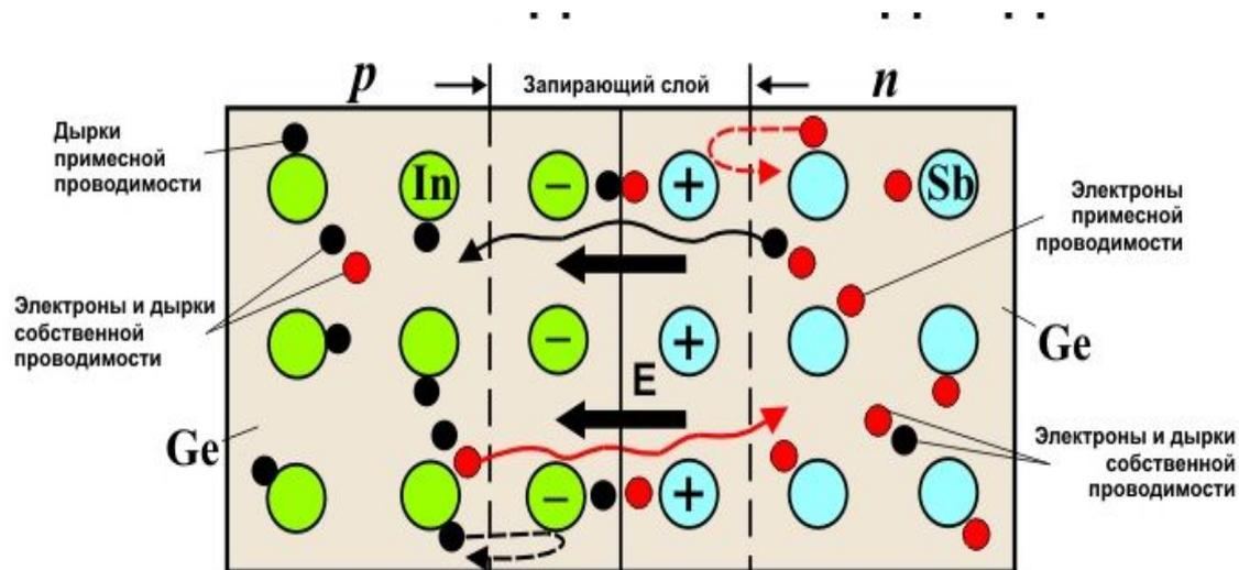
Схема образования электрического поля  $E$  на границе раздела p- и n- полупроводников
