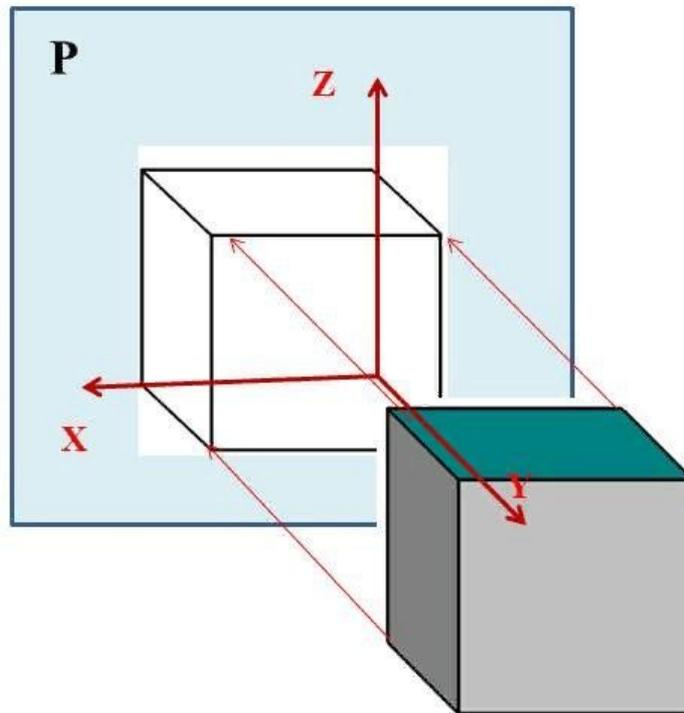
При построении фронтальной диметрической проекции по осям  $x$  и  $z$  (и параллельно им) откладывают действительные размеры; по оси  $y$  (и параллельно ей) размеры сокращают в 2 раза, отсюда и название "диметрия", что по-гречески означает "двойное измерение".
