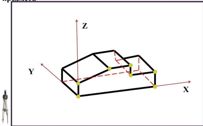
**Построение изометрической проекции плоскогранного предмета**
