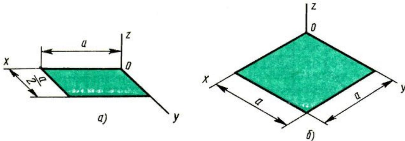
Рис. 88. Аксонометрические проекции квадрата: а - фронтальная диметрическая; б - изометрическая
