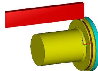
Точение канавки  $\phi 82 \times 3$
