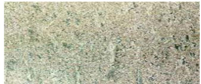
**Sa 1:** Легкая дробеметная очистка. Поверхность должна быть очищена от видимых частей масла, смазки и грязи. Допускается присутствие частиц ржавчины и краски.
