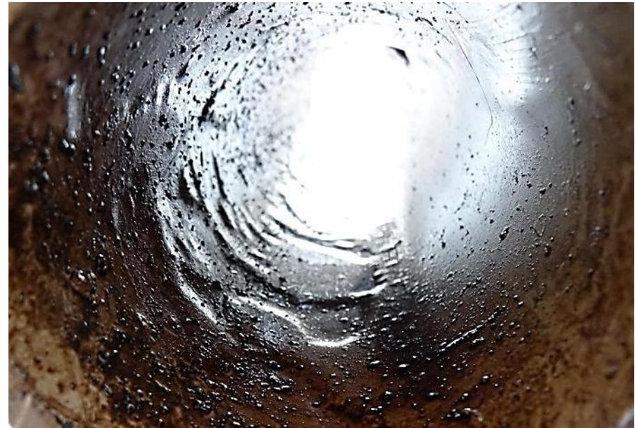
Мониторинг работы подвесок б/у НКТ с покрытием на скважинах показал, что процент отбраковки после эксплуатации в течение 600-800 суток, составляет 3 - 4%
