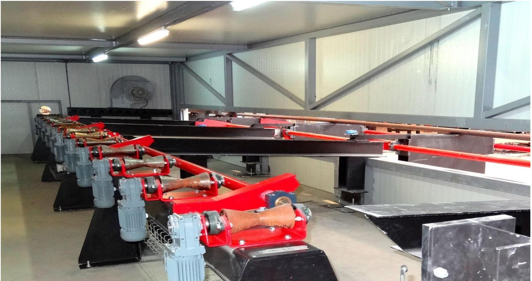
После охлаждения труба подается на линию контроля качества нанесенного покрытия
