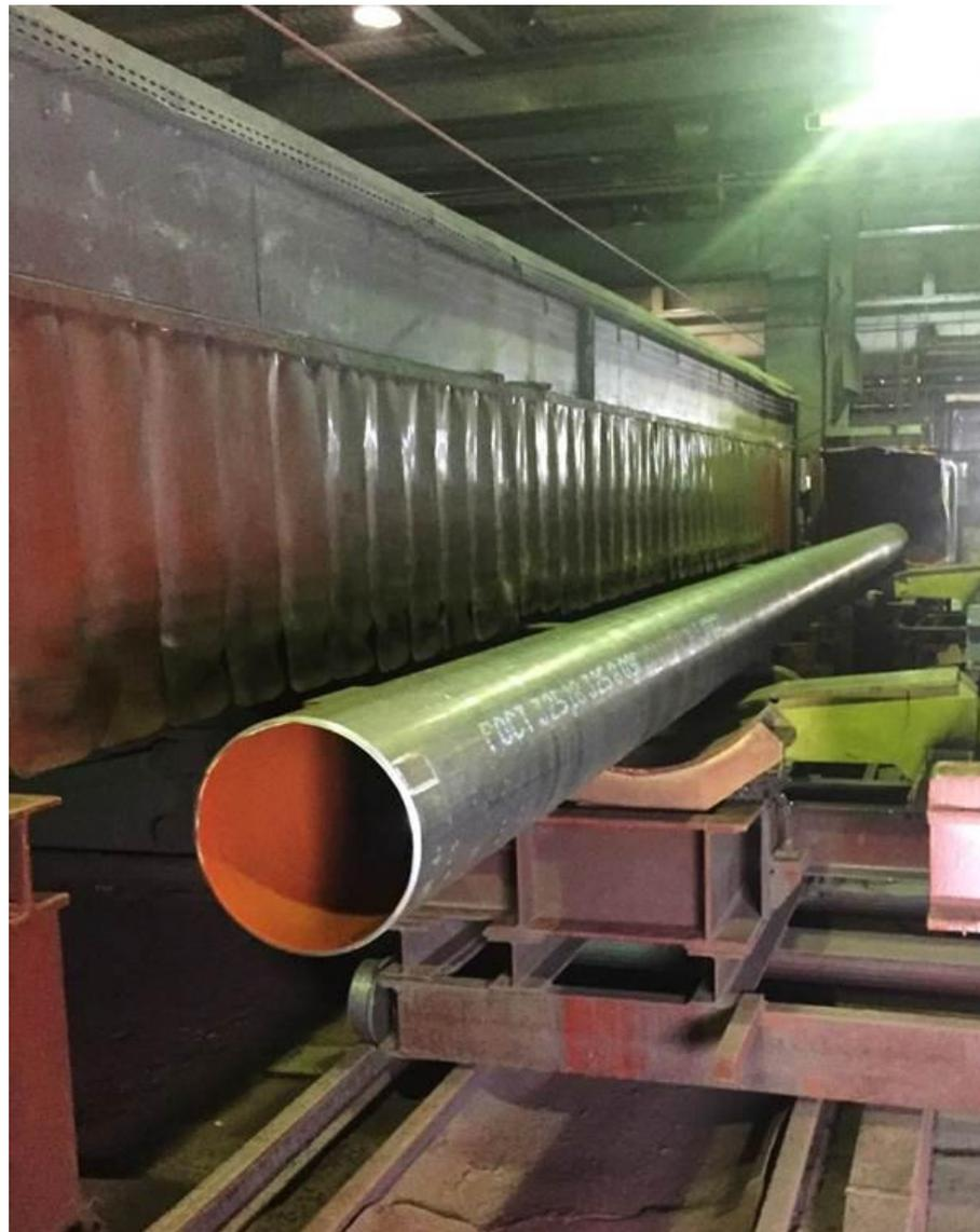
*Интервал времени между окончанием дробеметной/ дробеструйной очистки и нанесением покрытия – 2 часа*
