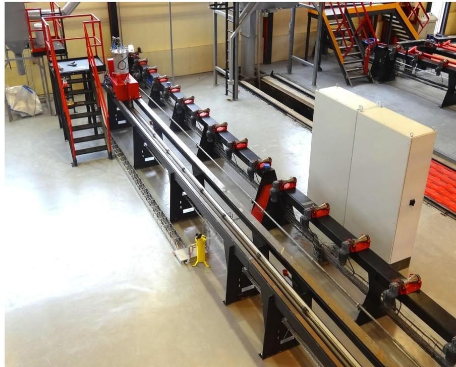
Применение системы распыления праймера марки ТК - 8007 обеспечивает толщину покрытия по всей длине трубы в пределах 8-12 мкм. Покрытая труба подается в печь полимеризации праймера и предварительного нагрева трубы.
