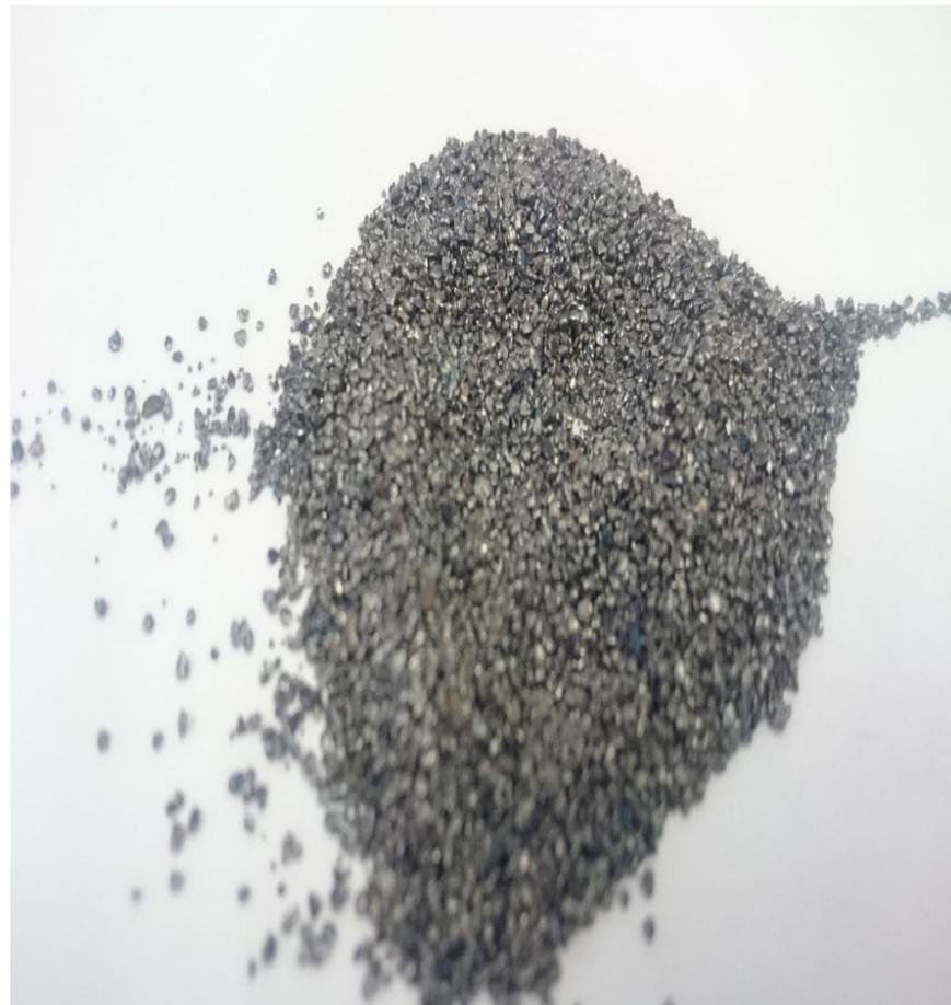
Регулярно, в зависимости от  $\sigma_{\text{в}}$  стали трубы, проводятся испытания новых видов дробы для обеспечения необходимой степени очистки и увеличения производительности
