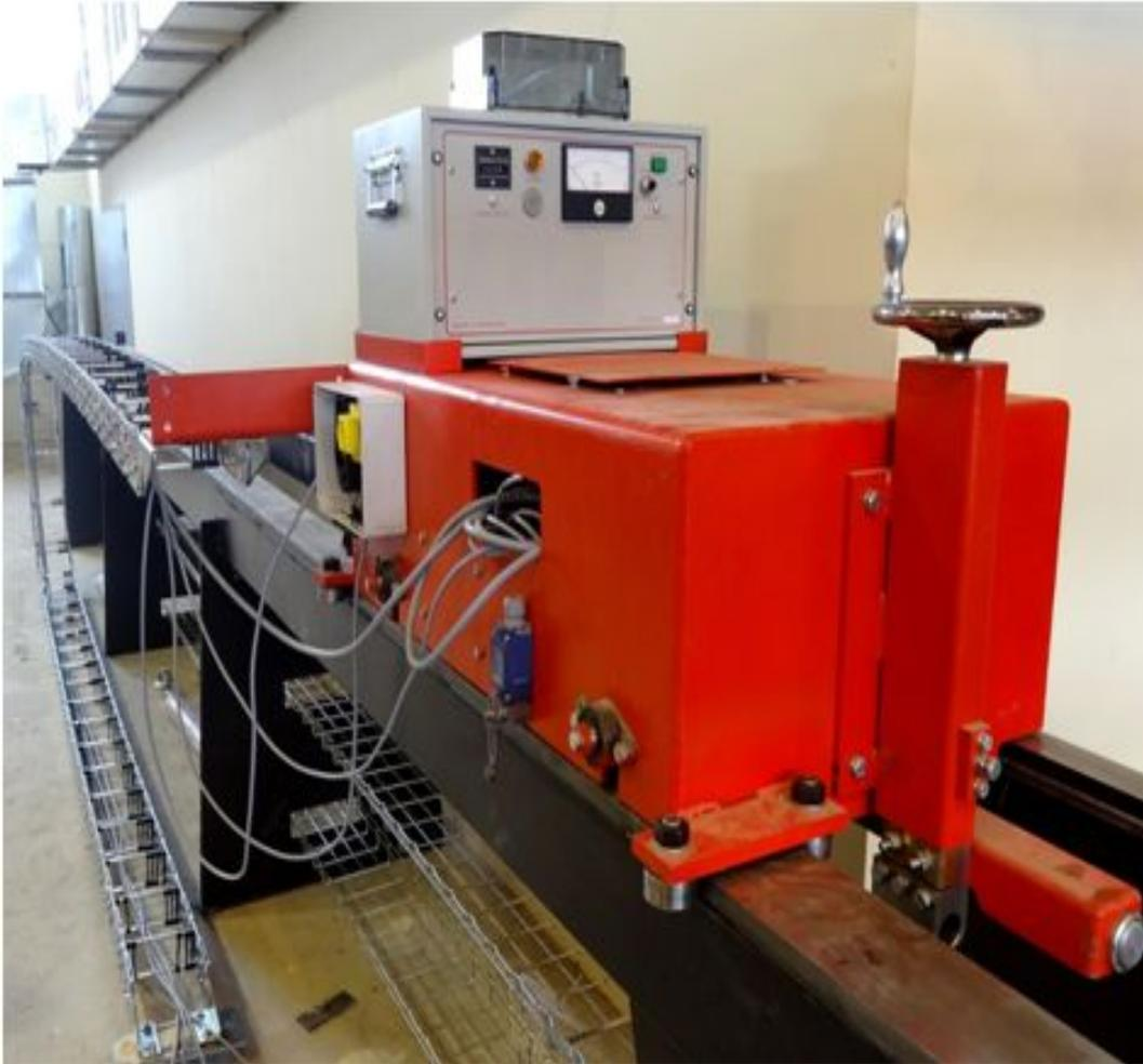
**-контроль сплошности покрытия по всей длине трубы (электроискровой метод);**
