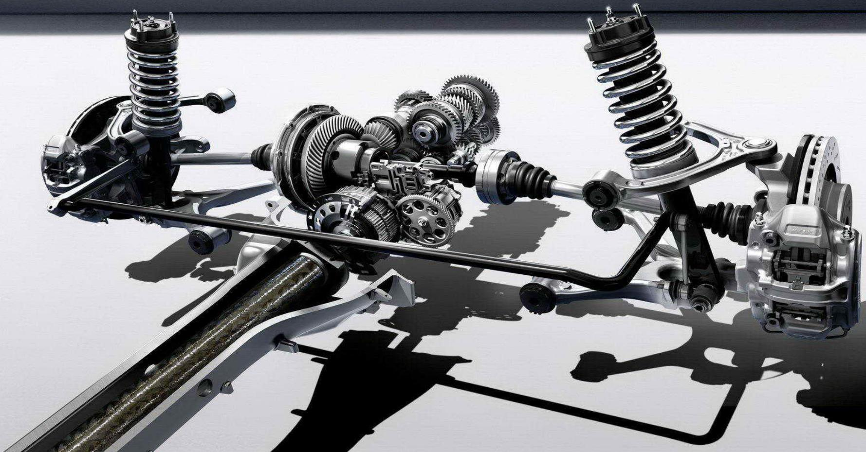
В соответствии с типом упругого устройства подвески называются рессорными, пружинными, торсионными и пневматическими.
