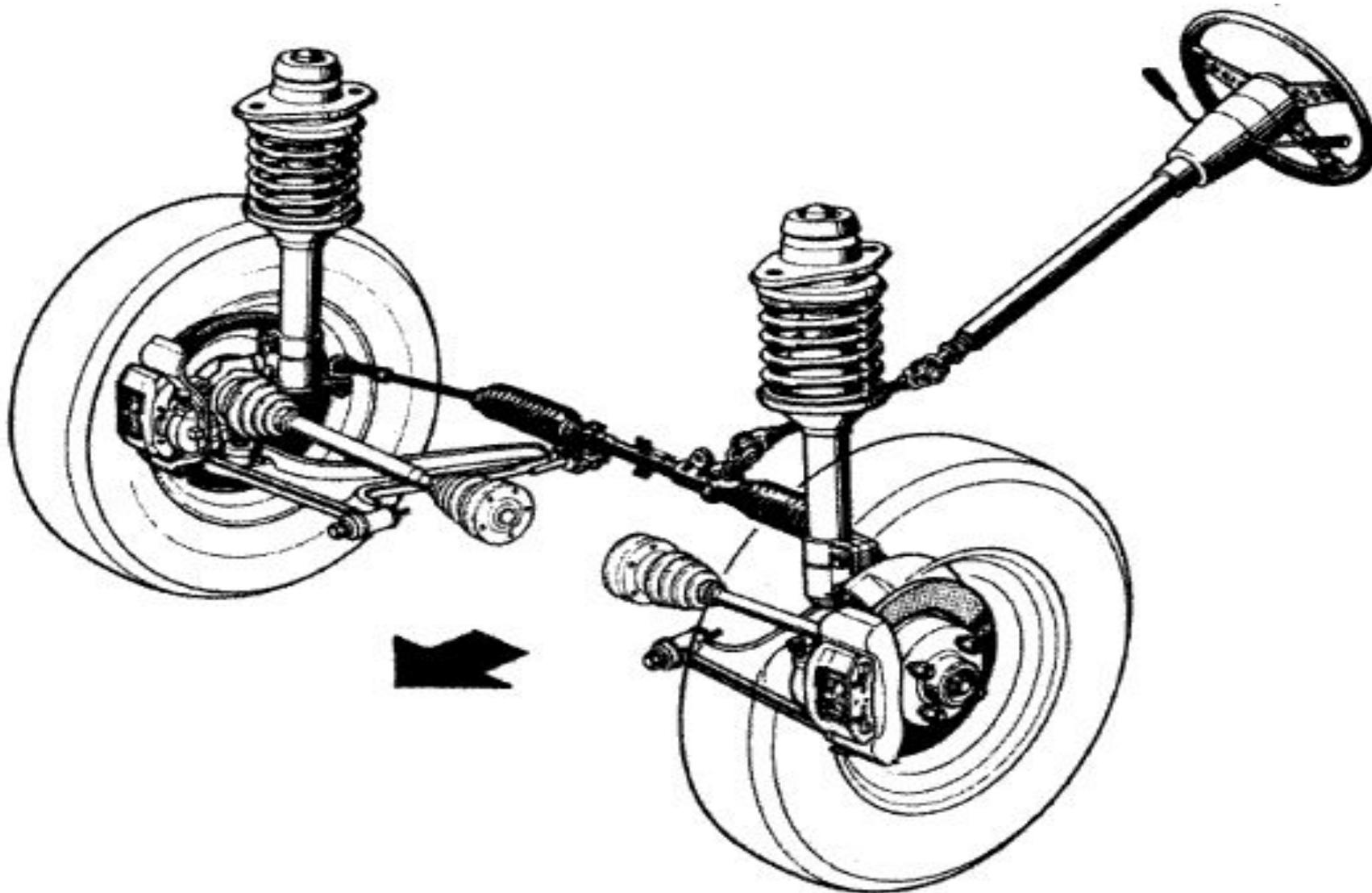
Винтовые пружины, расположенные вокруг амортизаторной стойки, обычно устанавливаются под некоторым углом к ее оси. Такой способ установки обеспечивает снижение величины «пороговой жесткости» подвески, когда сначала при небольших вертикальных усилиях со стороны колеса не происходит сжатия пружины, а затем она сжимается довольно резко.
