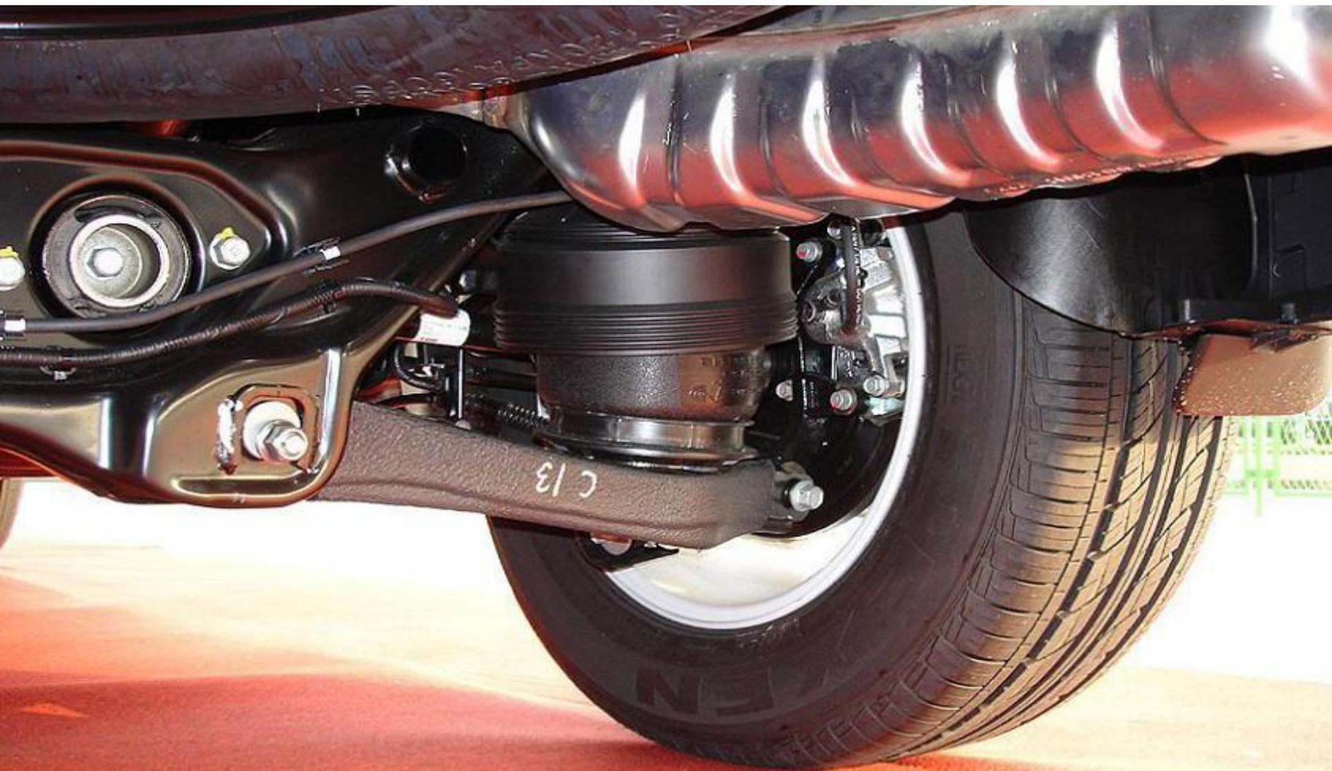
В соответствии с типом упругого устройства подвески называются рессорными, пружинными, торсионными и пневматическими.
