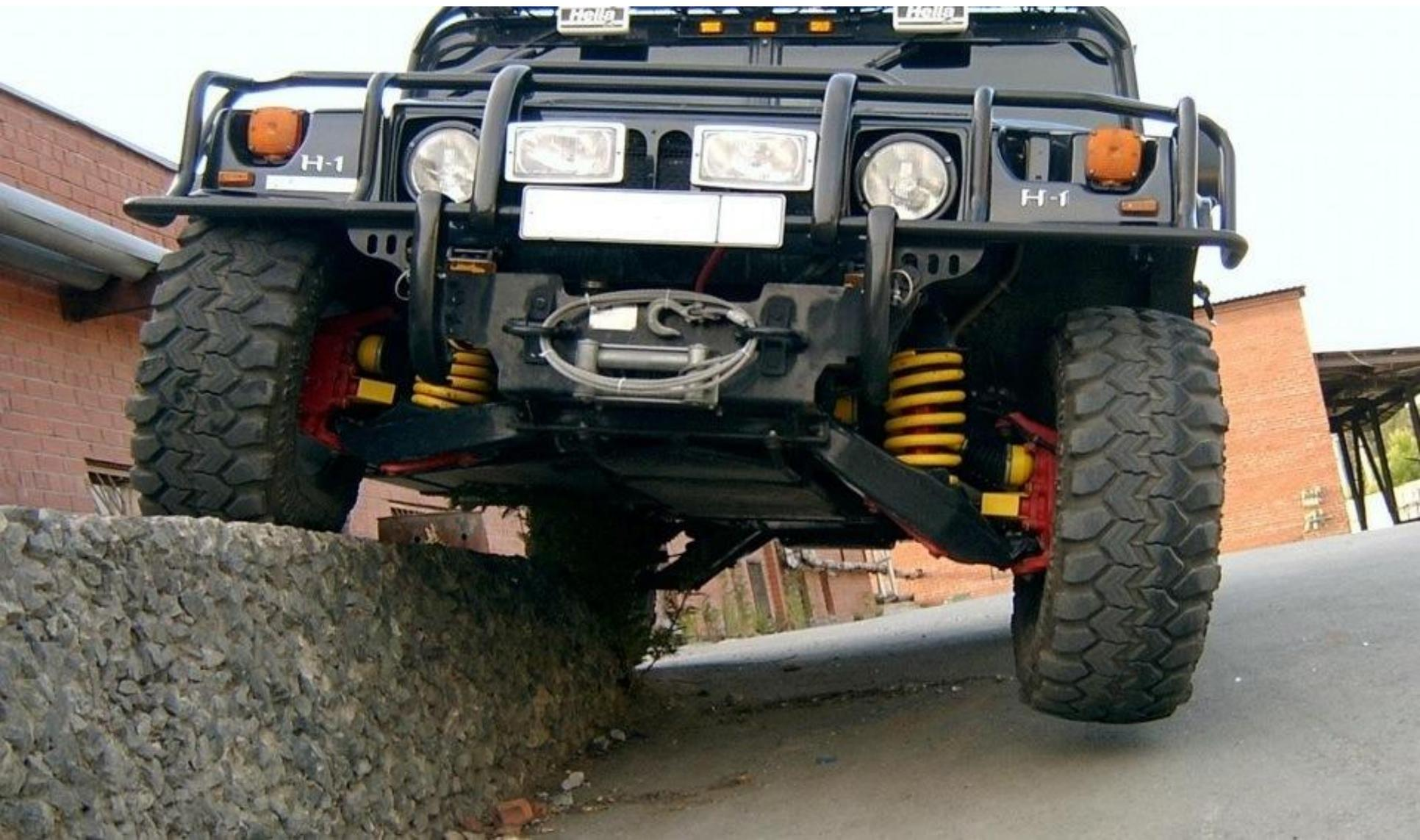
В соответствии с типом упругого устройства подвески называются рессорными, пружинными, торсионными и пневматическими
