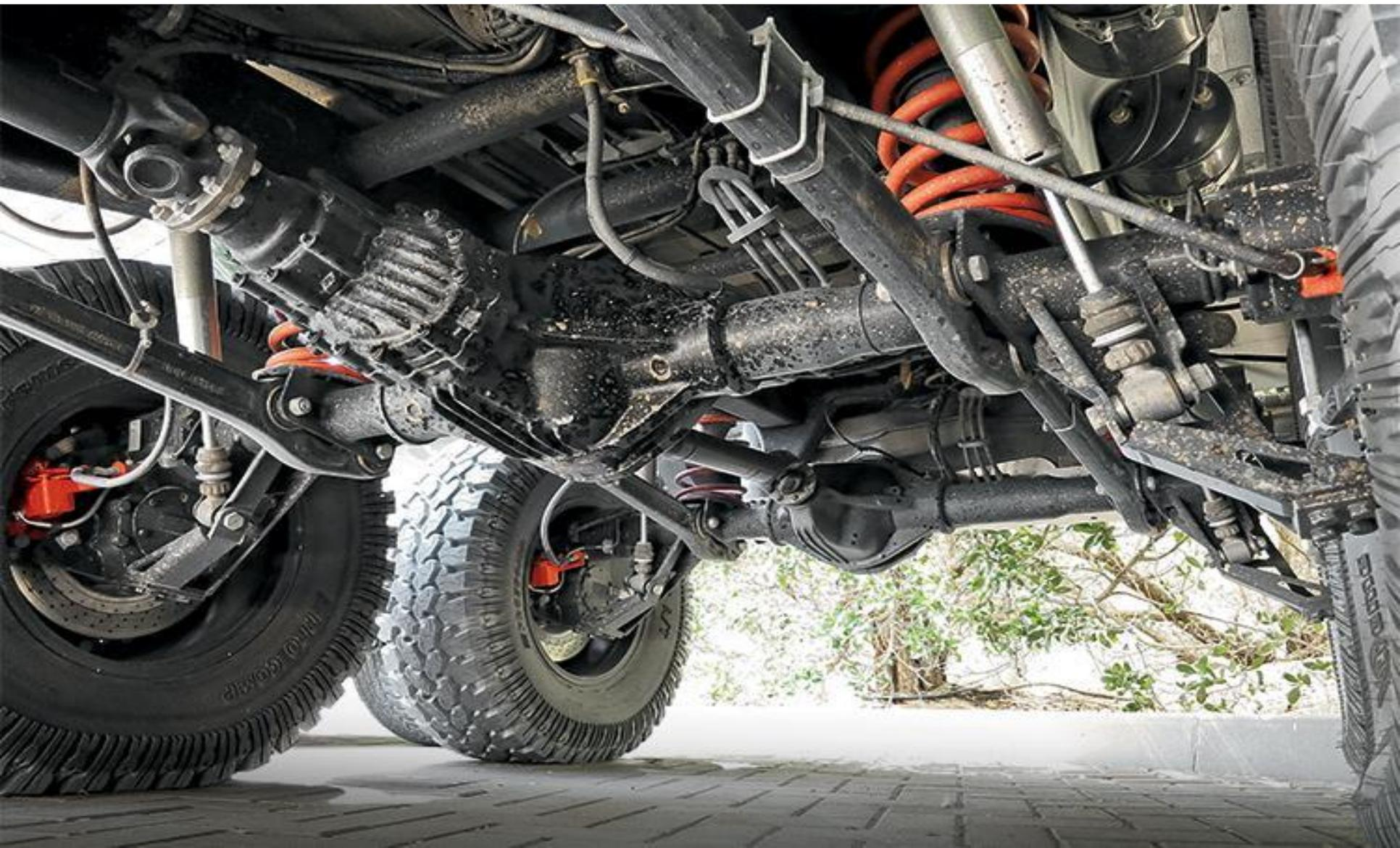
Мостами автомобиля называются металлические балки с колесами.
