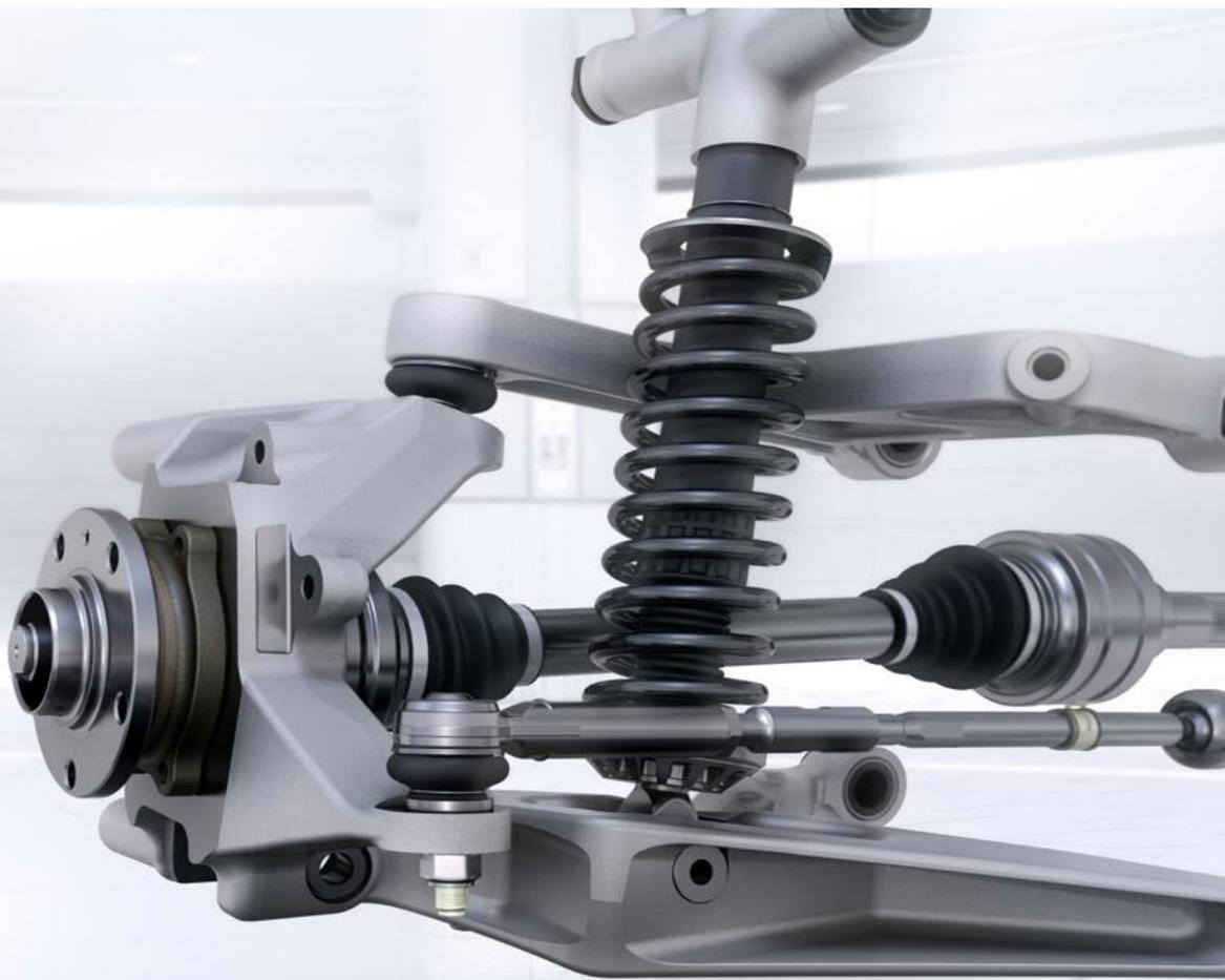
Подвески на двойных рычагах современных автомобилей имеют не только разную длину рычагов, но и наклон рычагов в горизонтальной плоскости
