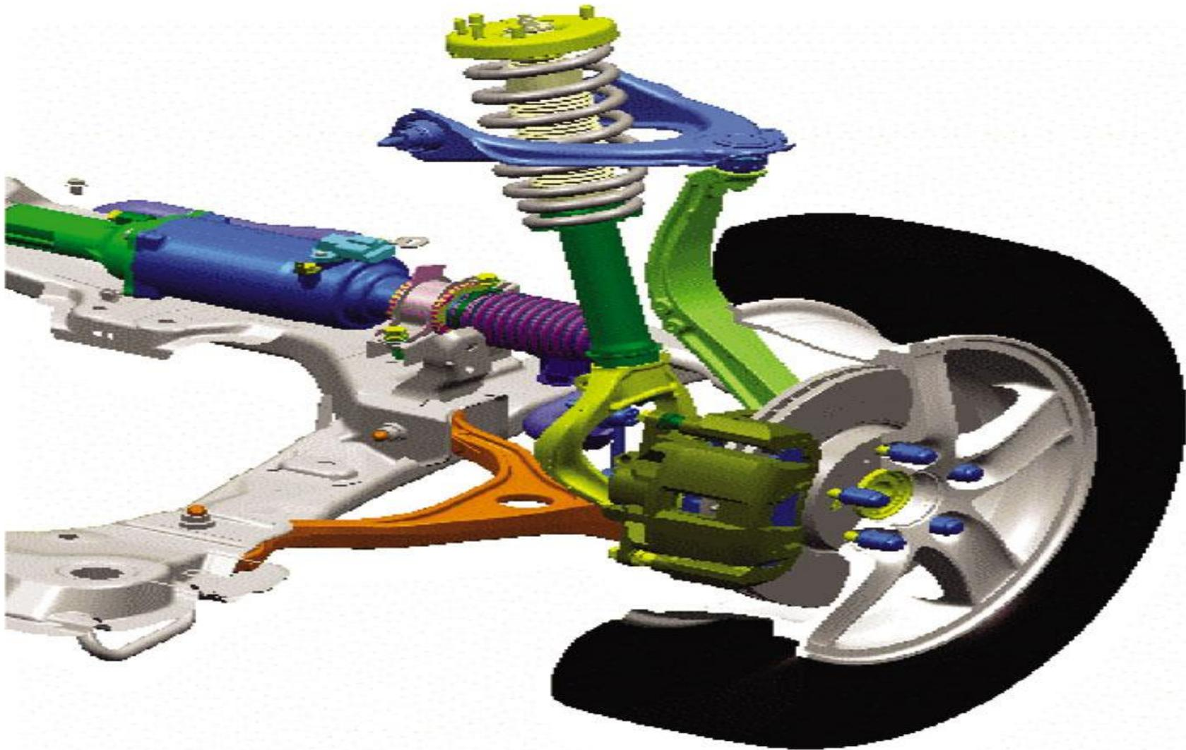
Передняя подвеска автомобиля **Jaguar S-type** имеет двойные поперечные рычаги и очень длинный рычаг поворотной цапфы. Такая конструкция обеспечивает большое пространство для размещения агрегатов под капотом автомобиля
