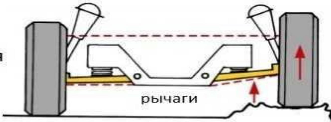
На легковых автомобилях зависимые подвески применяют обычно для задних колес. Они просты по конструкции и в обслуживании, имеют малую стоимость
