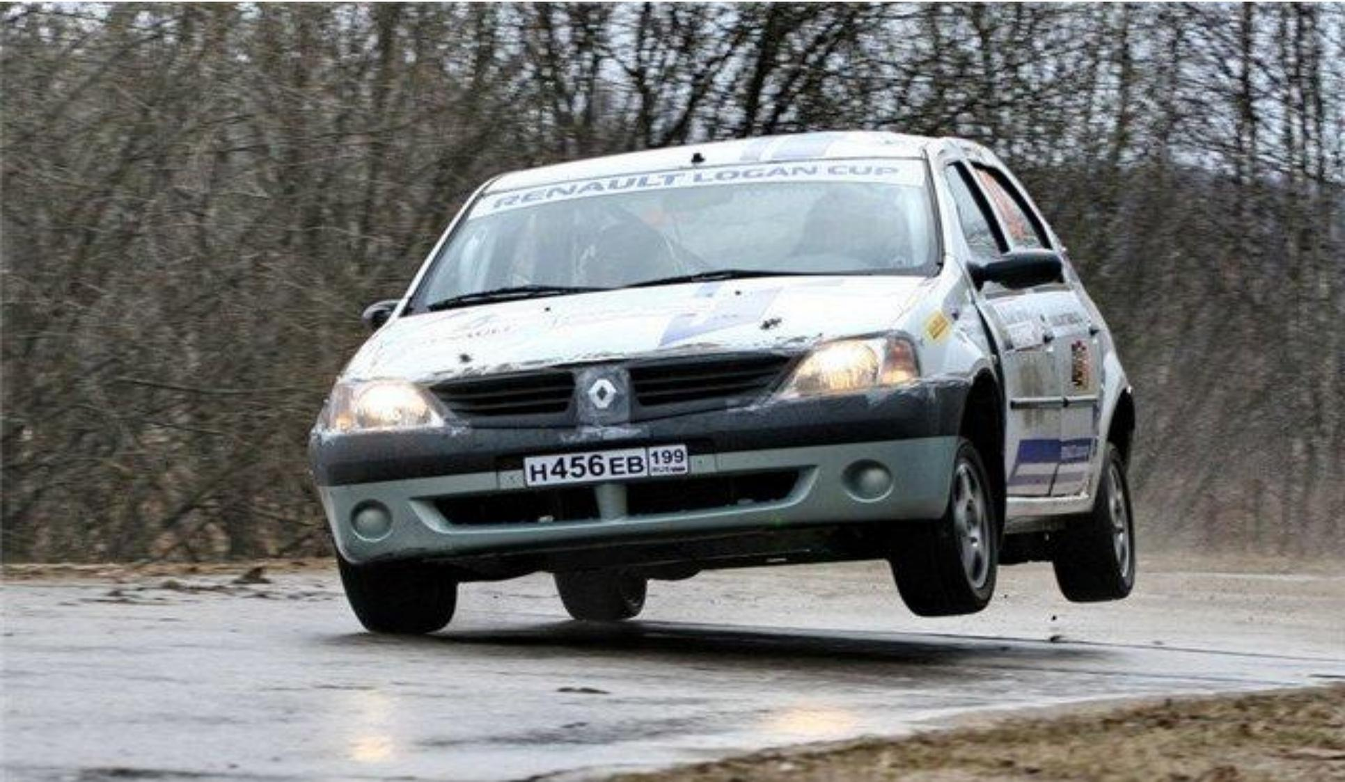
При прохождении поворотов, колеса наклоняются под углом, равным крену кузова. Такой наклон приводит к некоторому уменьшению силы сцепления колес с дорогой
