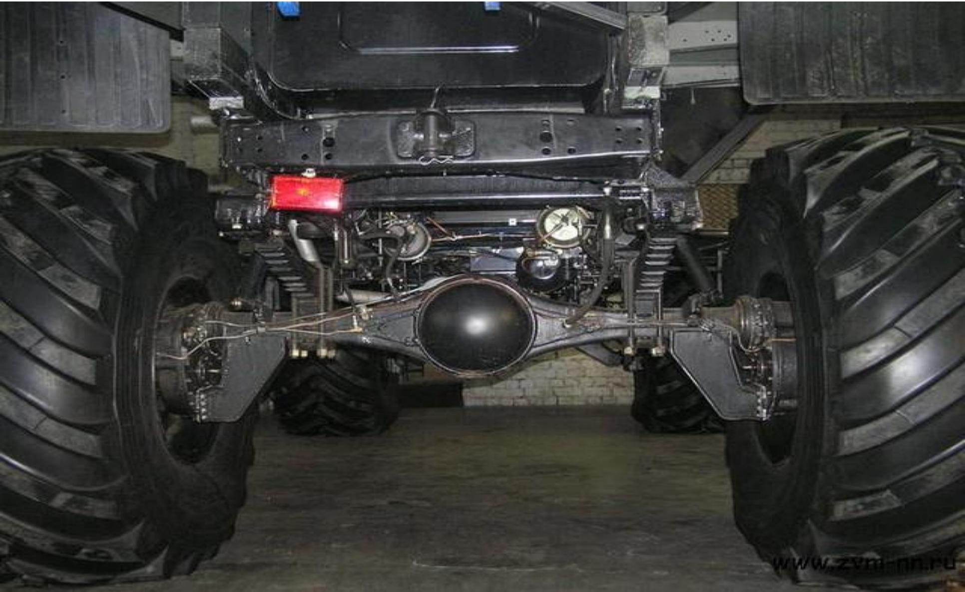
**Зависимой** называется подвеска при использовании которой колеса одного моста связаны между собой жесткой балкой, вследствие чего перемещение одного из колес вызывает перемещение другого колеса
