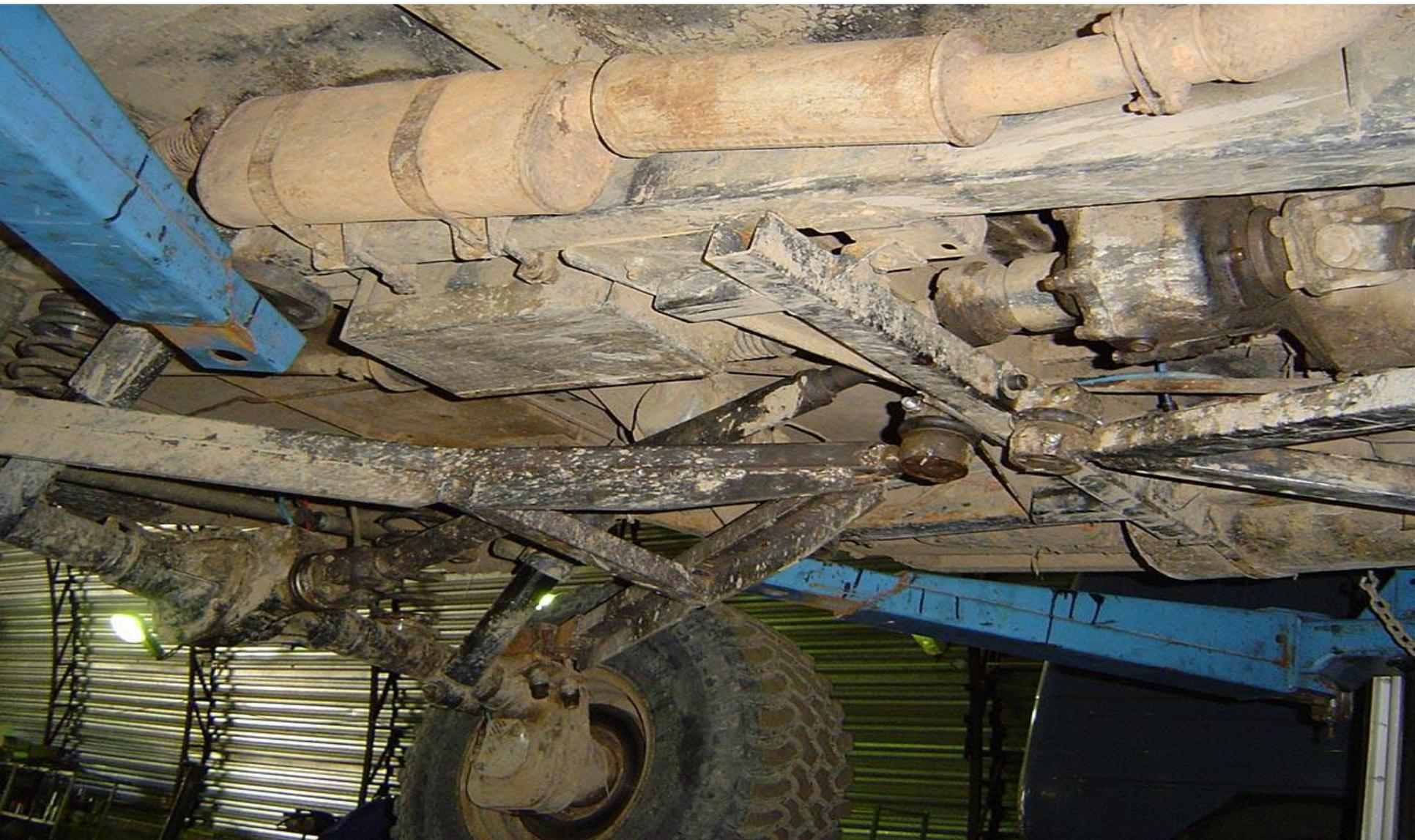
Подвеска на продольных рычагах, нагруженных на изгиб,
