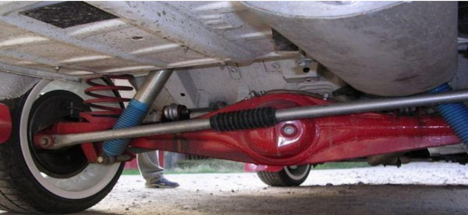
На легковых автомобилях зависимые подвески могут применяться для передних колес, как правило на автомобиля высокой и повышенной проходимости
