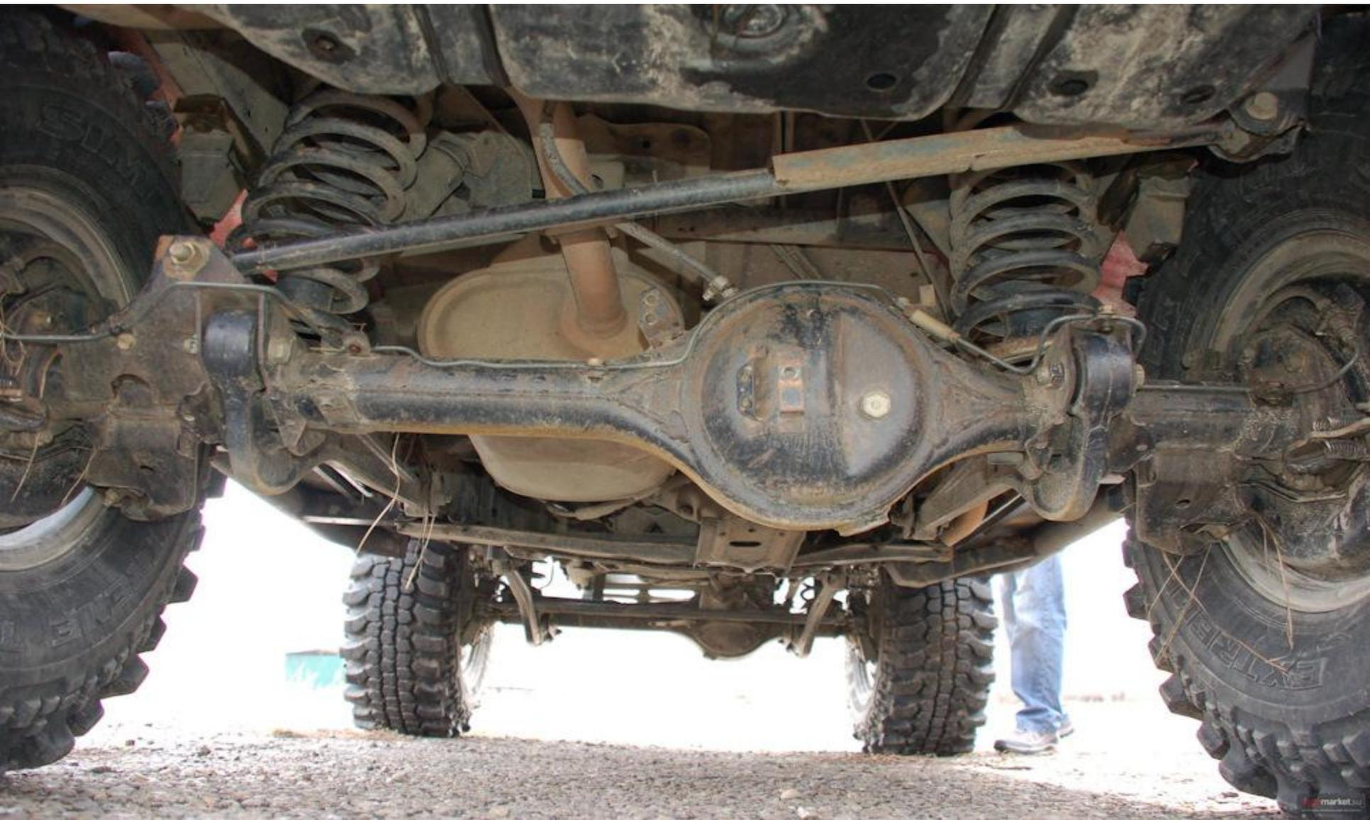
Подвеской называется совокупность устройств, осуществляющих упругую связь колес с несущей системой автомобиля (рамой или кузовом)
