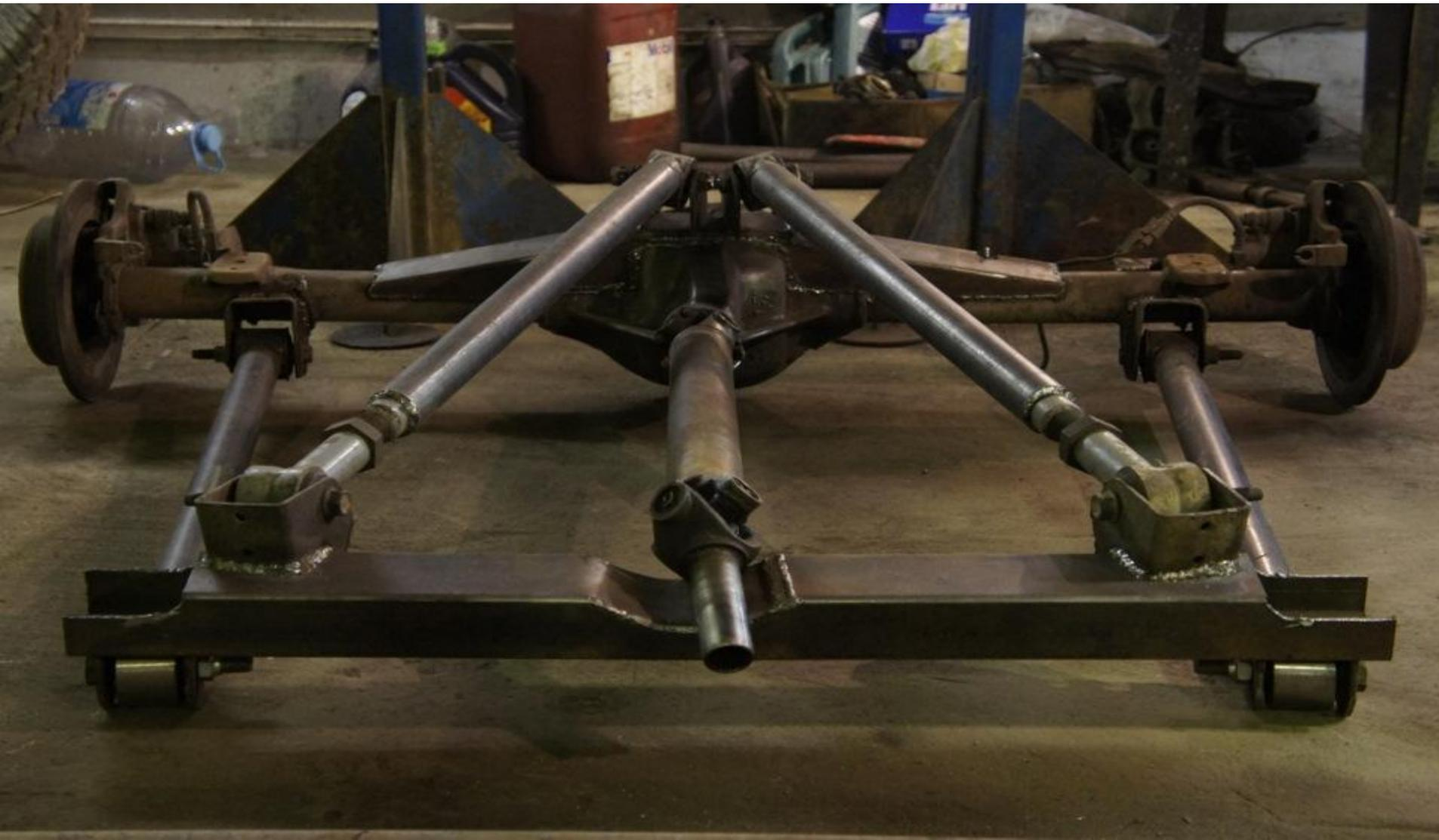
Подвеска на продольных рычагах, нагруженных на изгиб, со связанными рычагами (торсионная балка)
