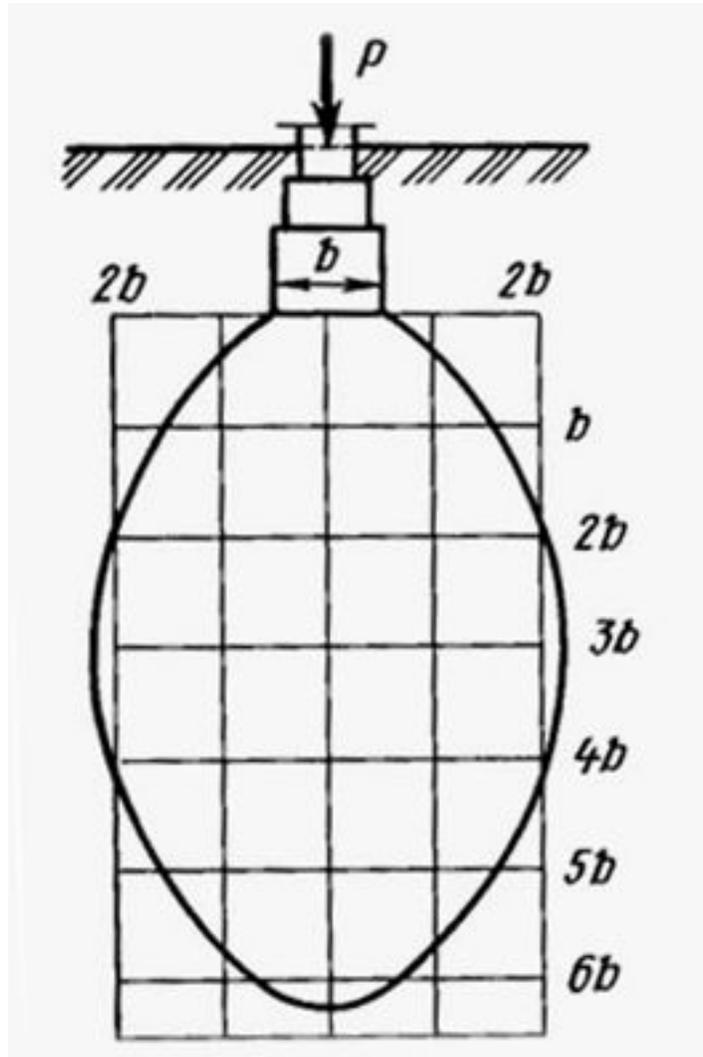
Рис. 4.1. Напряженная зона грунта основания под подошвой фундамента:
