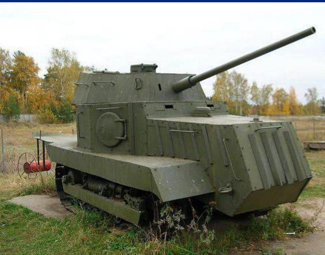
Бронированный трактор НИ-1, применявшийся при обороне Одессы.
