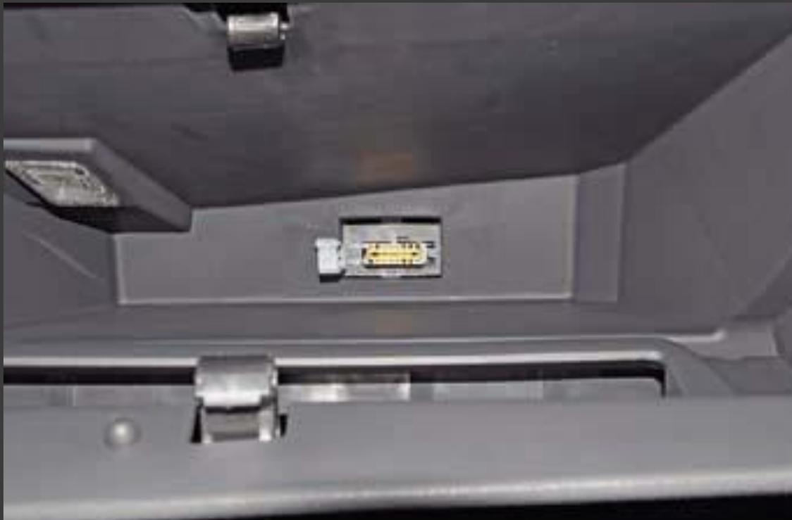
Колодка диагностики (диагностический разъем) расположена в салоне автомобиля – в вещевом ящике панели приборов. Разъем OBD2.
