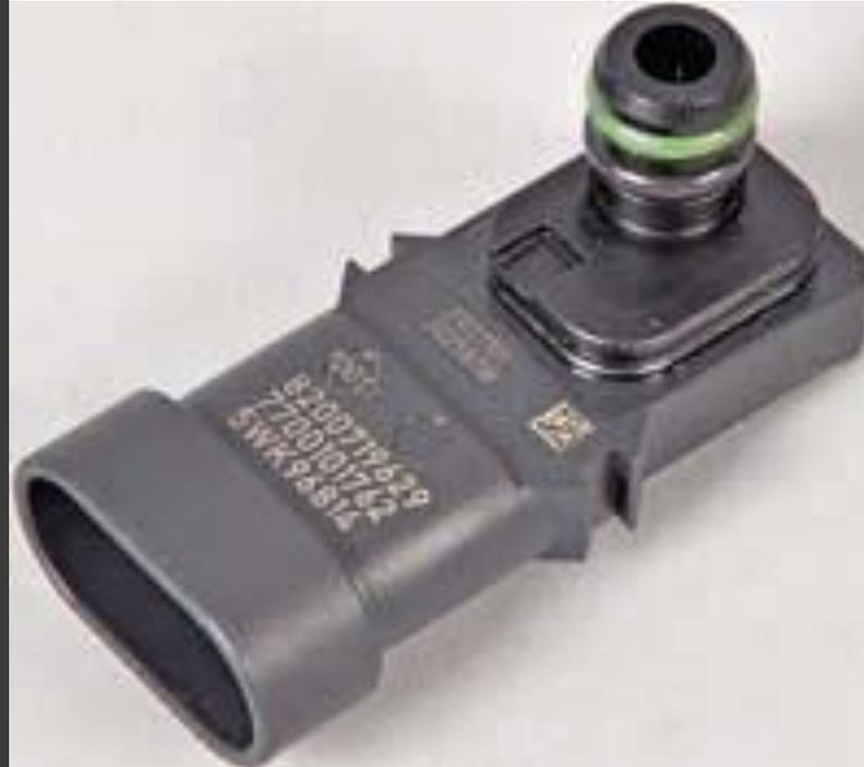
Датчик абсолютного давления воздуха установлен сверху справа на ресивере воздушного тракта двигателя.
