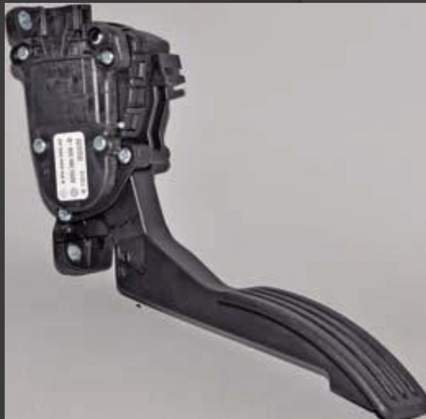
Положение педали отслеживается с помощью двух датчиков угловых перемещений (расположенных в модуле педали «газа»), которые передают сигналы ЭБУ.
