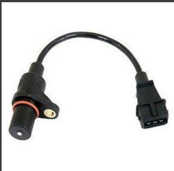
Момент начала впрыска топлива в камеру сгорания определяется положением поршня в цилиндре двигателя. Все поршни соединяются с коленчатым валом с помощью шатунов и, следовательно, датчик частоты вращения коленчатого вала обеспечивает получение информации о положении всех поршней в цилиндрах. Частота вращения определяется числом оборотов коленчатого вала в минуту. Эта важная входная переменная рассчитывается в ЭБУ по сигналу индуктивного датчика частоты вращения коленчатого вала.
