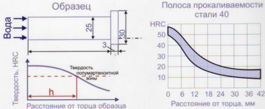
Под **закаливаемость** понимают способность стали после заковки. Так же зависит от содержания углерода в стали: чем больше содержание углерода, тем выше прокаливаемость. При повышении содержания углерода в стали увеличивается количество пересыщенного мартенсита, что приводит к увеличению внутренних напряжений и возникновению трещин. Если в углеродистой стали содержится мало углерода, то такая сталь уже не
