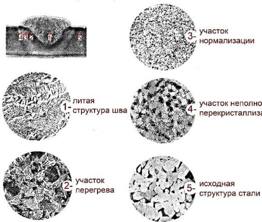
Структура углового сварного шва стали Ст.3, выполненного ручной дуговой сваркой
