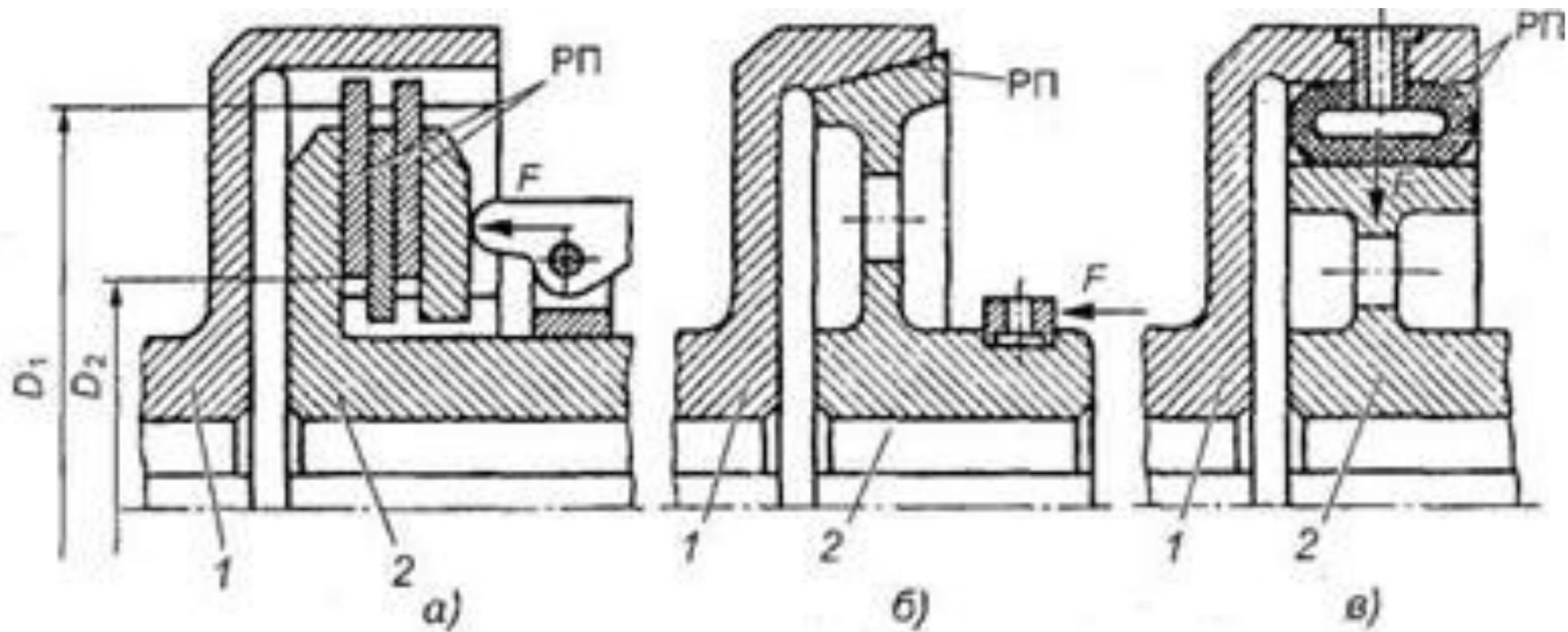
а — дисковая; б — конусная; в — цилиндрическая
