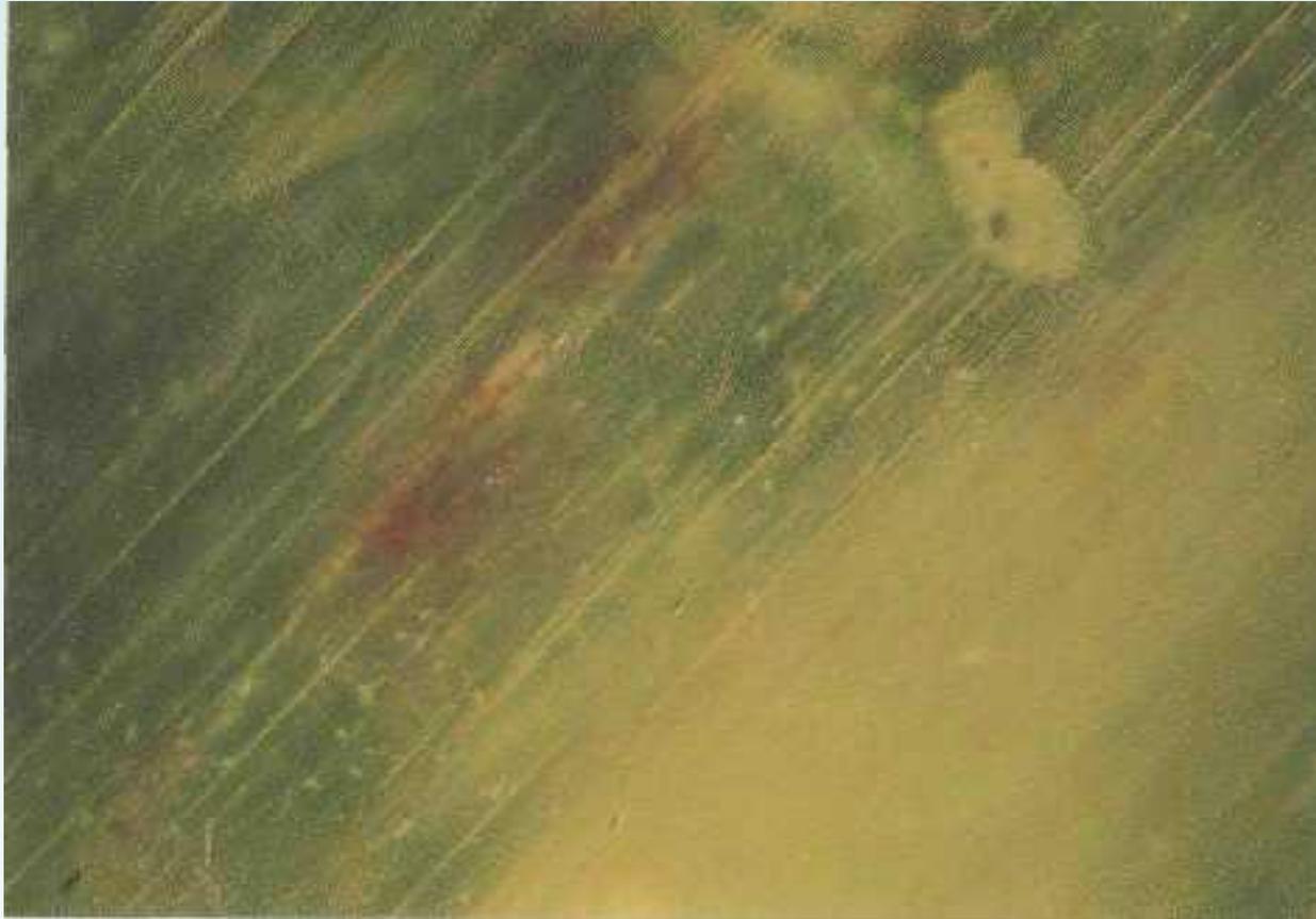
Камень в 1.25 карата содержит красно-коричневые ржавые пятна, ориентированные вдоль трещины. Они могут быть результатом окисления частичек никель - содержащего железа метеоритного происхождения. Увел.  $30\times$ . (Синканкас и др., 1992)
