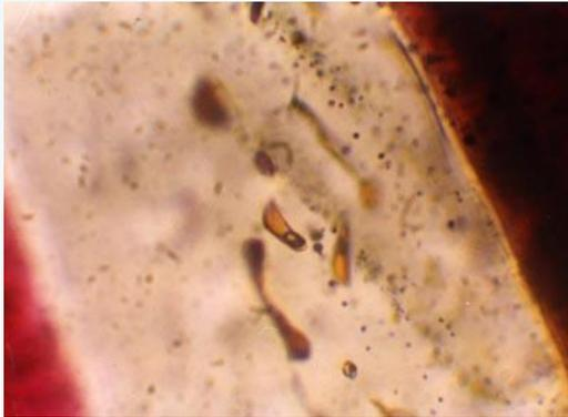
*Газово-твёрдые включения флюса в рубине, выращенном из раствора в расплаве. Размер включения 0.03 мм.*
