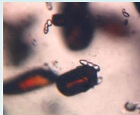
*Короткостолбчатые кристаллы рутила в рубине Индии. Размер включения 0.08 мм.*
