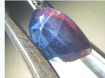
*Дублет: на поверхности склейки - «клеевые включения» - сферические включения воздуха*
