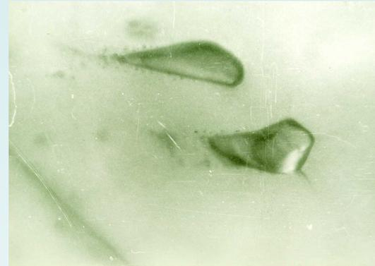
*Каплевидные затвердевшие включения расплава в хризоберилле.*
