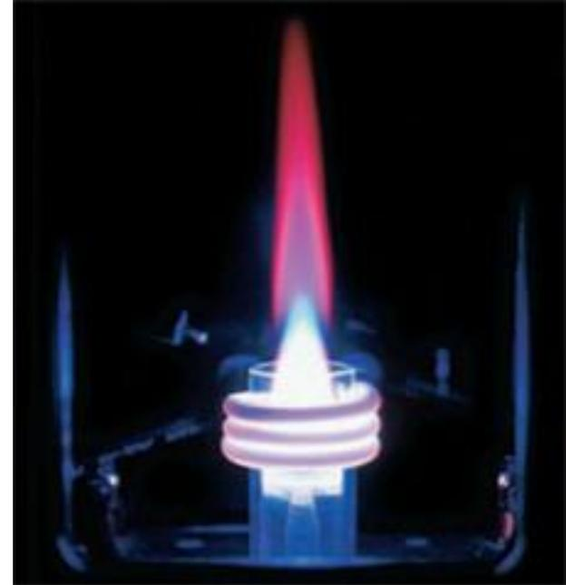
Температура газовой плазмы изменяется по высоте горелки и составляет 6000-10000 °С
