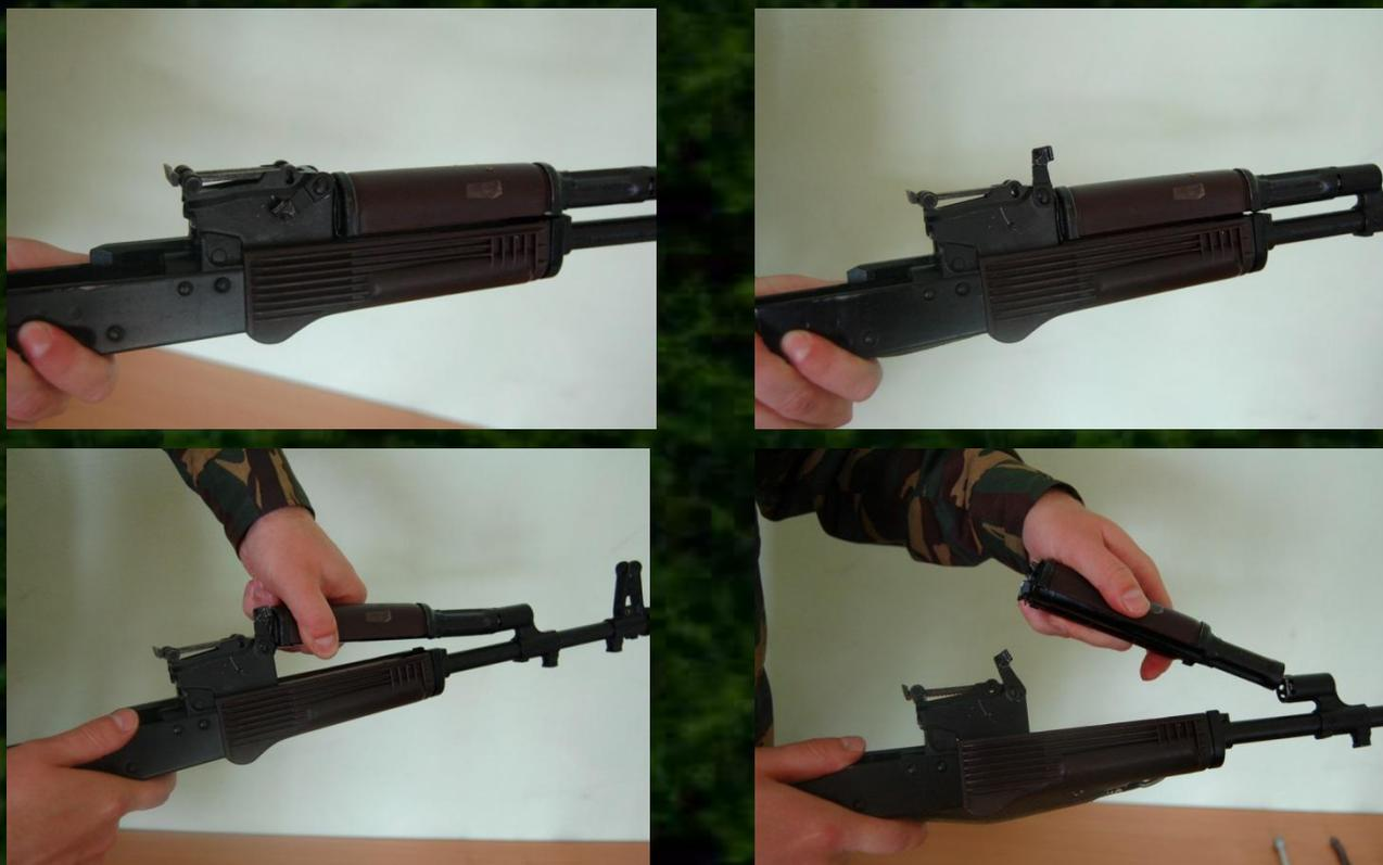
Рис. 8. Отделение газовой трубки со ствольной накладкой
