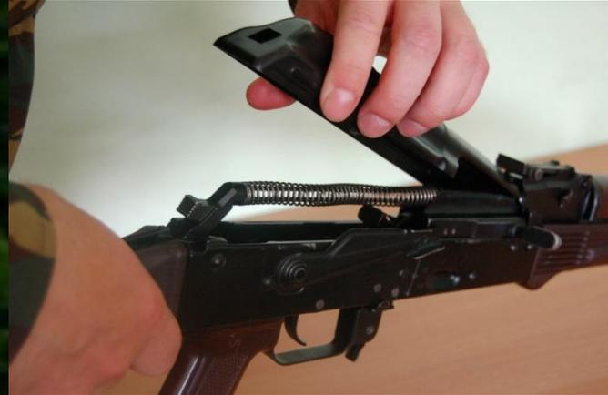
Рис. 4. Отделение крышки ствольной коробки
