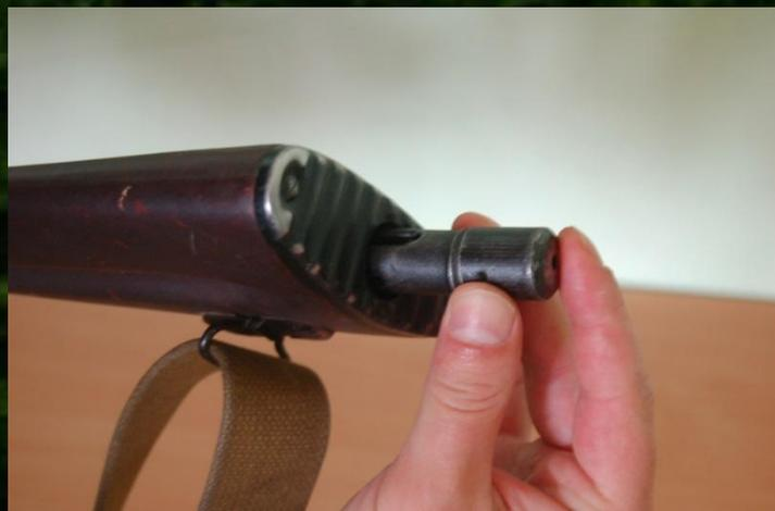
Рис. 2. Вынимание пенала с принадлежностью
