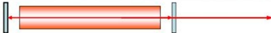
По типу **активных сред** лазеры подразделяются на **газовые** (на полностью или частично ионизованных газах и парах), **твердотельные** (диэлектрические, полупроводниковые), **жидкостные** (химические, лазеры на красителях), **на свободных электронах** и т.п. Известны лазеры на динамической плазме, например, **рентгеновские**  $\lambda \sim 10 \text{ нм}$  (разеры). Разрабатываются  **$\gamma$ -лазеры** (газеры).
