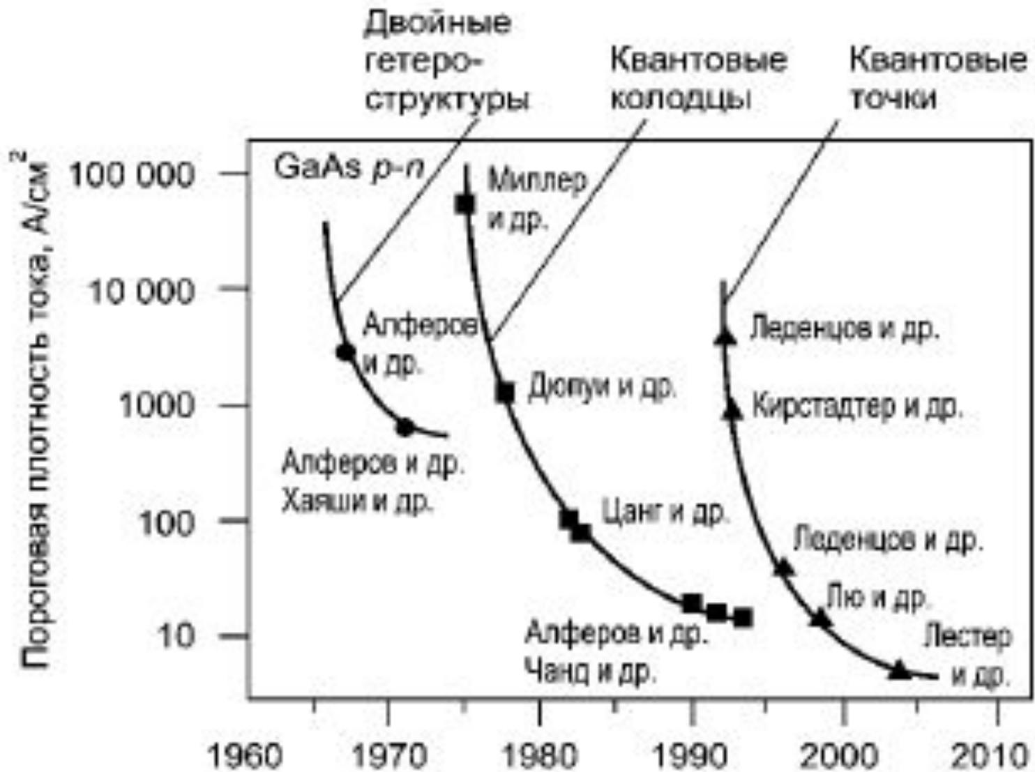
Эволюция полупроводниковых лазеров от арсенид-галлиевых на  $p-n$  переходах до наноразмерных на квантовых точках
