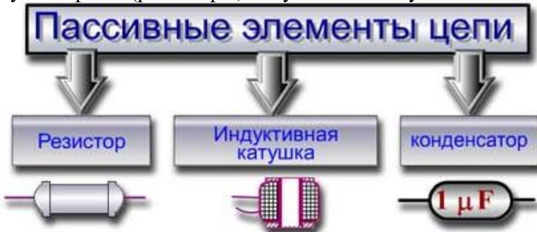
**Резистор** - пассивный элемент электрической цепи, обладающий определённым или переменным значением электрического сопротивления  $R$ . Линейно преобразует силу тока в напряжение и напряжение в силу тока, ограничивает ток и др. Это - диссипативный элемент (не может накапливать энергию): полученная им электрическая энергия необратимо в нем преобразовывается в тепловую.
