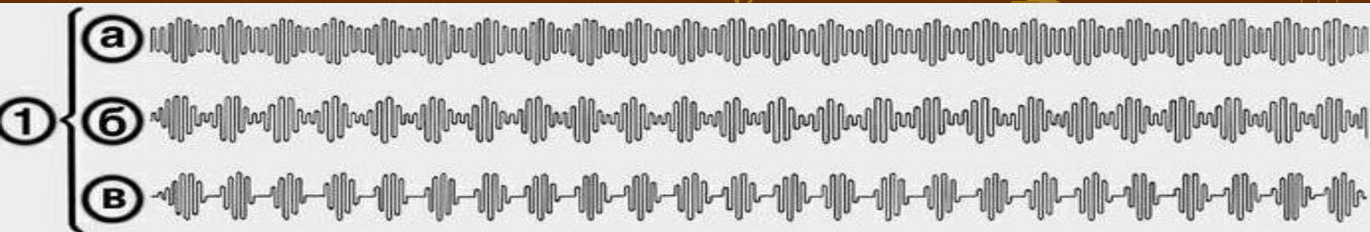
Модулированные колебания неполной (а), полной (б) и превышающей 100% (в) глубиной модуляции
