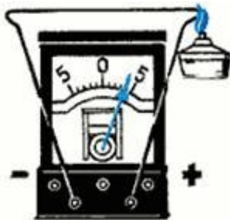
Преобразование внутренней энергии в электрическую.
