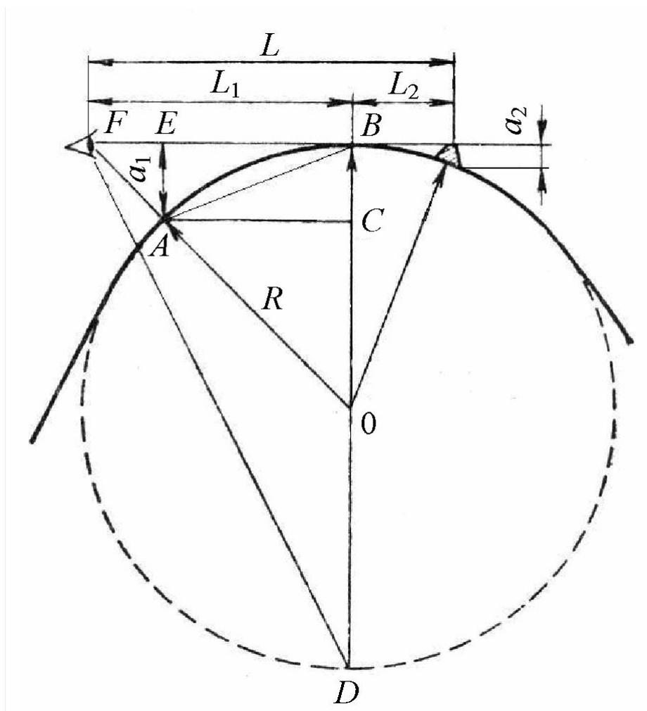
Схема к расчету радиуса вертикальной выпуклой кривой из условия видимости
