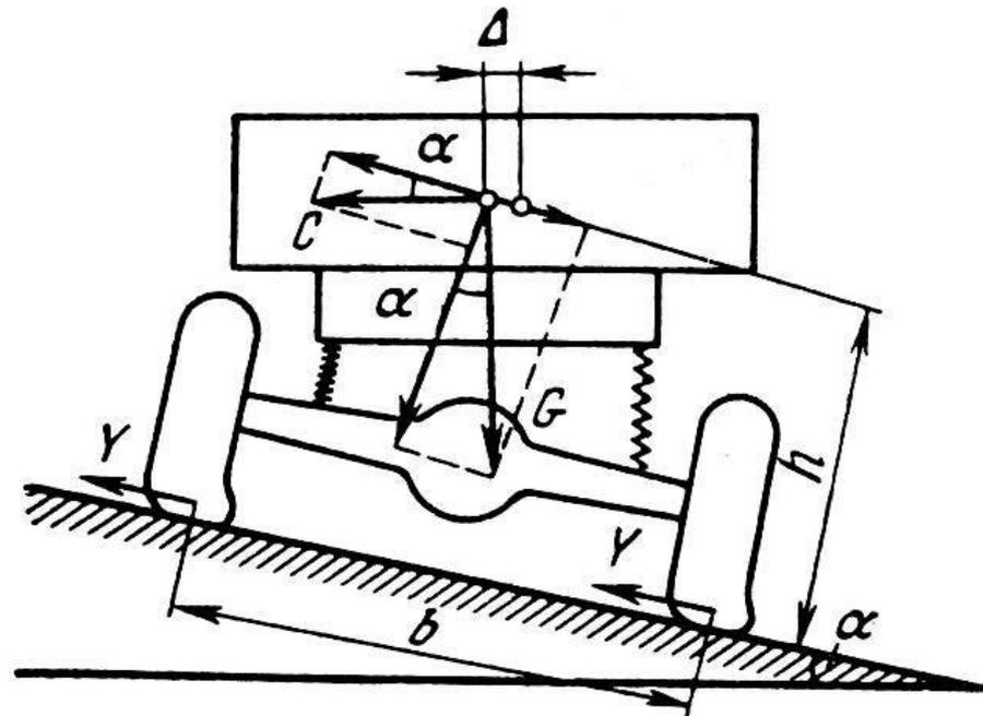
Силы, действующие на автомобиль при движении по кривой в плане
