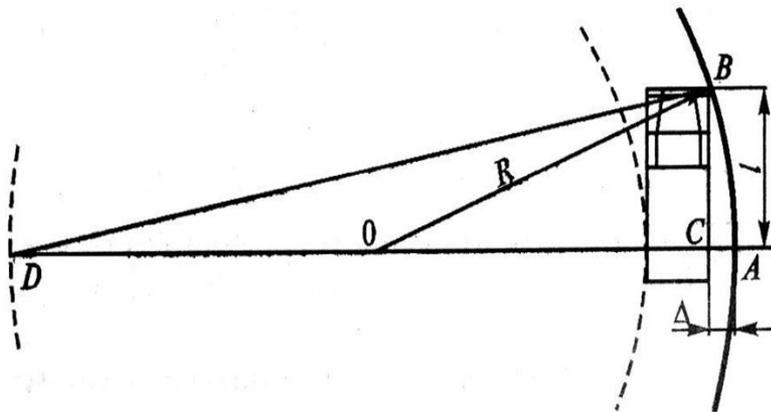
Расчетная схема определения уширения на кривой
