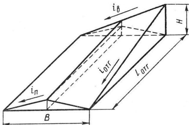
Схема к определению длины отгона виража
