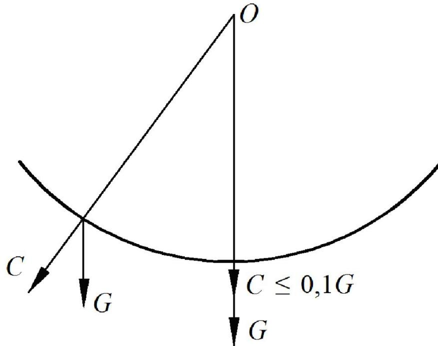
**Схема к определению радиуса вертикальной вогнутой кривой из условия допускаемой перегрузки рессор**
