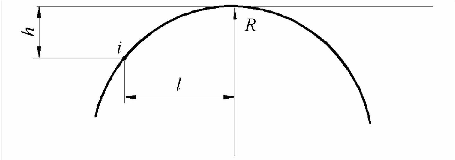
Величины уклонов касательных (в точках параболы) нарастают равномерно расстоянию  $l$  и обратно пропорционально радиусу кривой
