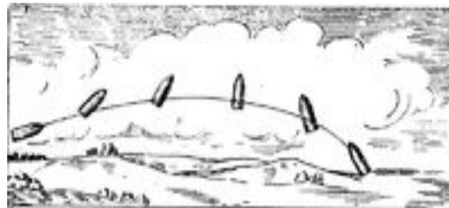
**Рис. 3. Вращение снаряда в полёте под действием силы сопротивления воздуха**
