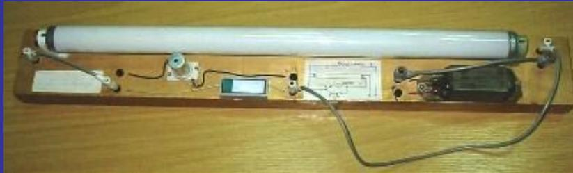
Схема подключения люминесцентной лампы
