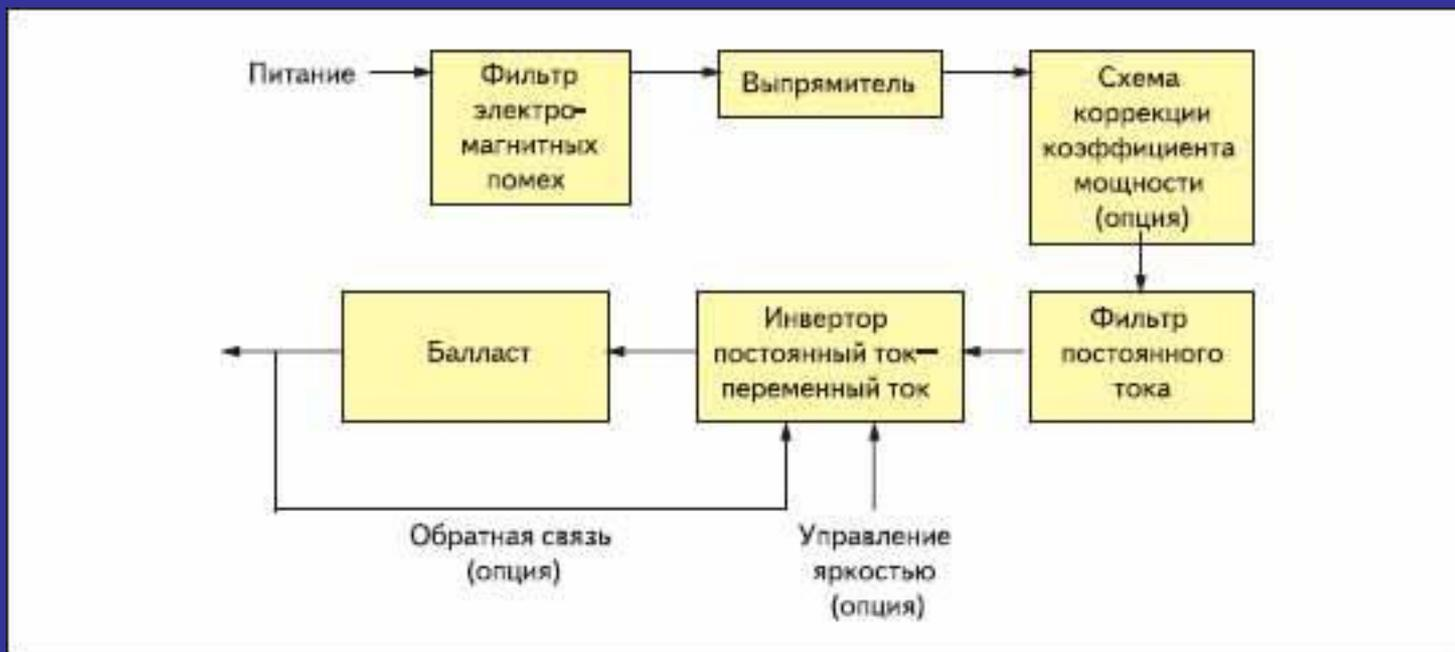
Рис. 3. Блок-схема электронного балласта
