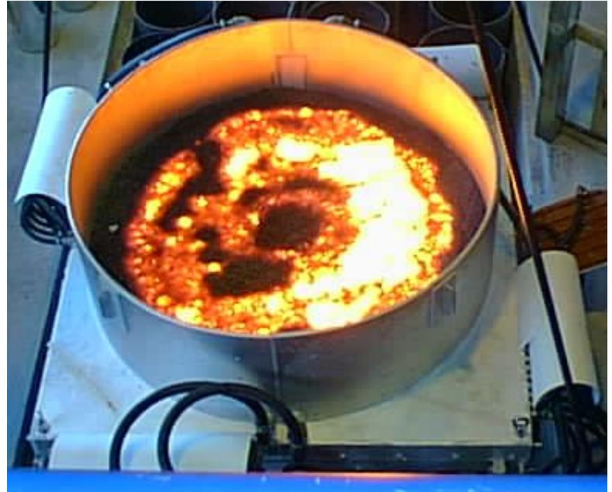
Плавка стекла в индукторе 1500 мм диаметром
