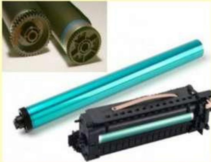
Таким образом создается сеть с отрицательным зарядом на положительно заряженной поверхности вращающегося барабана. К этим областям и притягиваются частицы положительно заряженного тонера.
