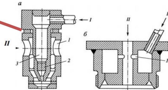
Схемы пневматических форсунок внутреннего (а) и внешнего (б) смешения
