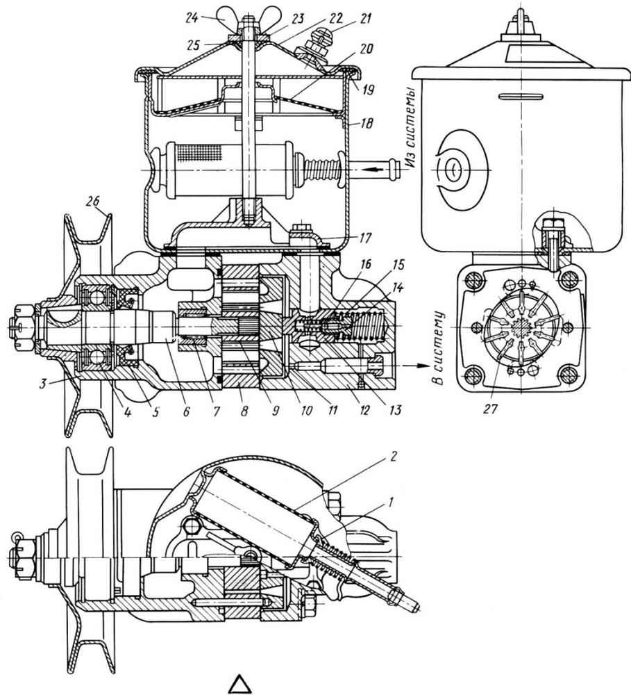
Внутри перепускного клапана установлен шариковый предохранительный клапан 16 ограничивающий давление масла 6,5-7 МПа.
