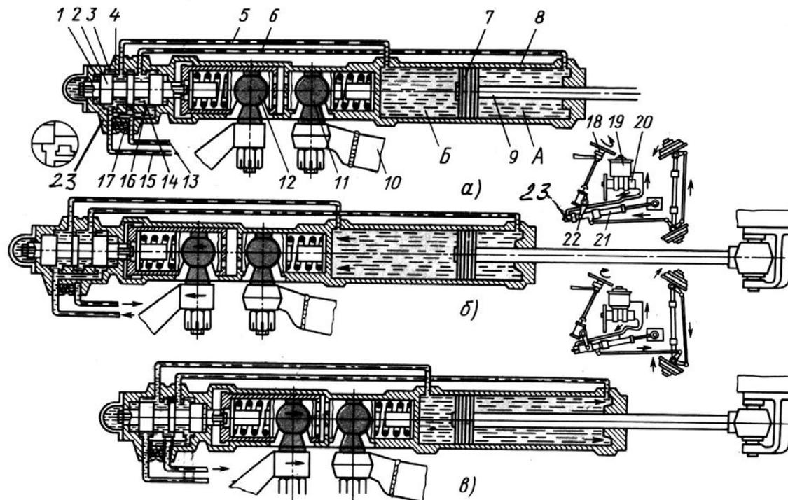
Из противоположной полости силового цилиндра 7 масло выдавливается и по сливной магистрали через клапан управления возвращается в насос гидроусилителя.
