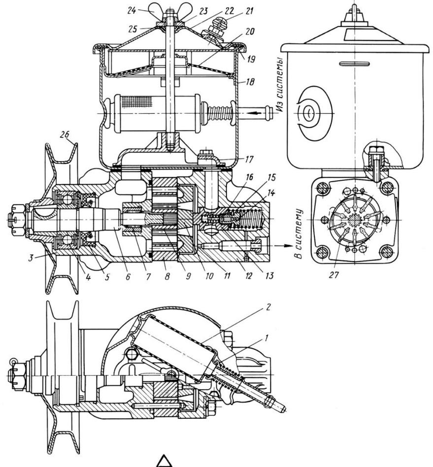
Насос состоит из корпуса 3 и крышки 12, между которыми зажат четырьмя болтами статор 8. В отверстиях статора 8 овальной формы установлен цилиндрический ротор 9 с прямоугольными пазами, в которых перемещаются лопасти 27. Между ротором 9 и статором 8 образуются клиновидные полости. Лопасти прижимаются к стенкам статора центробежной силой и давлением масла на их внутренние торцы.
