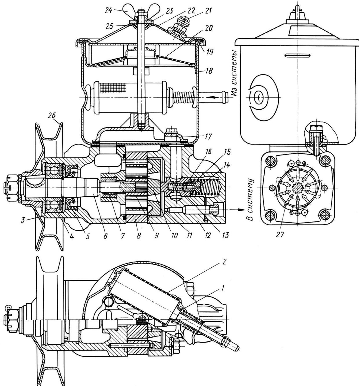
Насос гидроусилителя рулевого привода:
