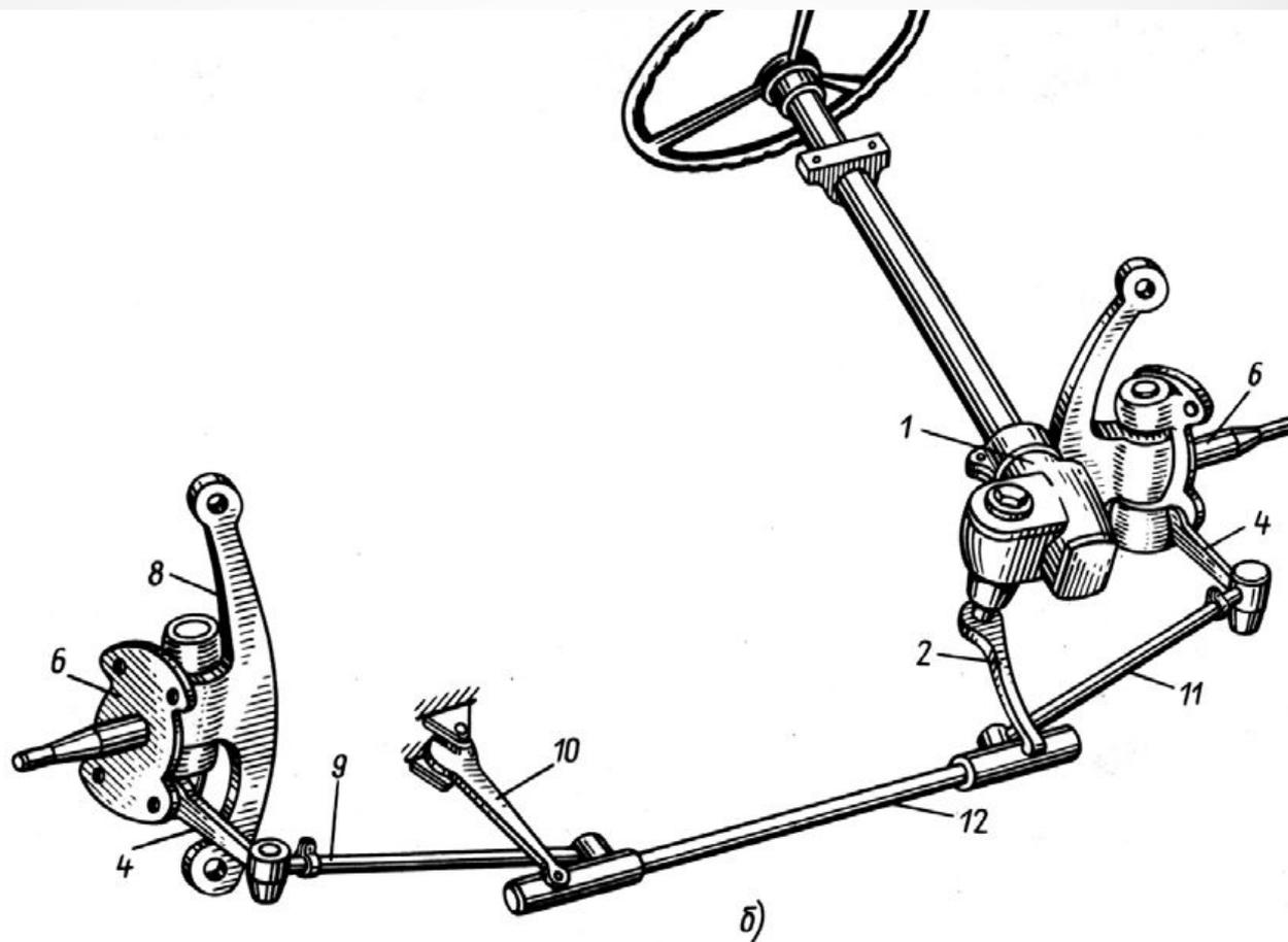
При независимой подвеске управляемых колес соединение их поворотных цапф жесткой поперечной рулевой тягой нарушило бы возможность независимого перемещения колес; поэтому рулевая трапеция расчленена и состоит из двух боковых тяг 9 и 11 (.б) и шарнирно соединенной с ними средней тяги 12. Средняя тяга 12 также шарнирно связана с сошкой 2 и маятниковым рычагом 10, поворачивающимся вокруг цилиндрической шарнирной опоры на кузове автомобиля.
