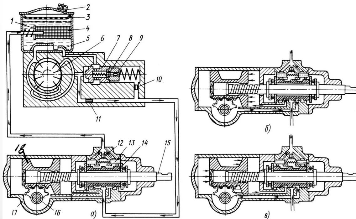
В поршне 18 винтами закреплена шариковая гайка, в которую ввернут винт 15 с циркулирующими шариками. Картер 17 герметично закрывается крышками. Над верхней крышкой крепится корпус клапана управления. На винте между двумя упорными шарикоподшипниками смонтирован золотник 14, имеющий на наружной поверхности две выточки.
