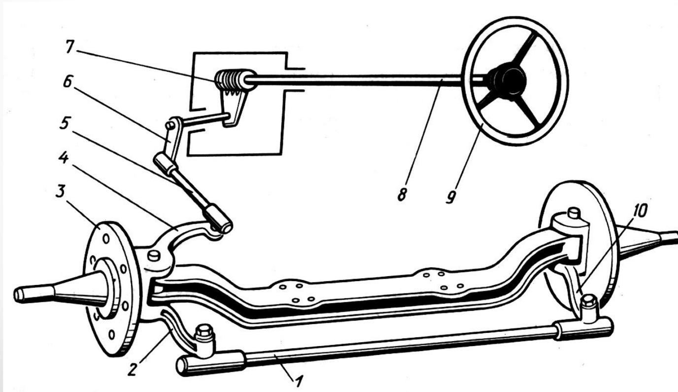
Рулевая трапеция обеспечивает поворот управляемых колес на необходимые неодинаковые углы, благодаря чему колеса двухосного автомобиля двигаются по траекториям, представляющим собой дуги концентрических окружностей с общим центром  $O$ . Это обеспечивает качение колес при повороте без существенного скольжения.
