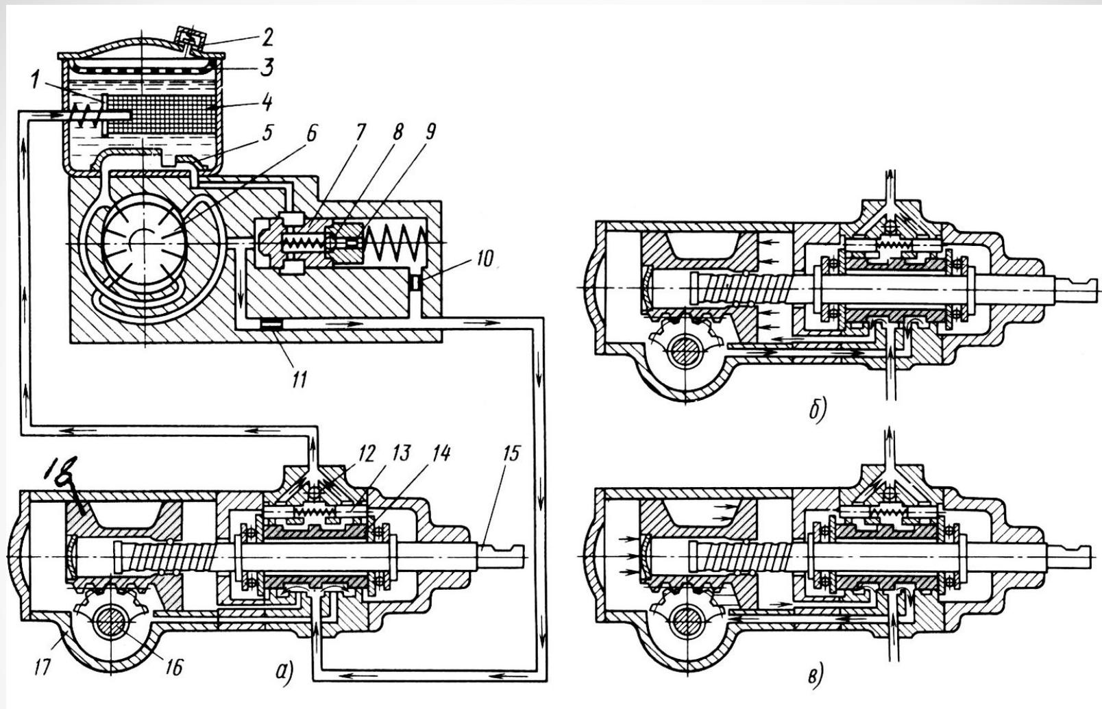
Схемы работы гидроусилителя рулевого привода автомобиля ЗИЛ
