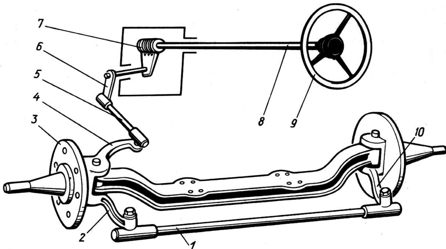
Рулевым механизмом называют понижающую передачу, увеличивающую приложенный к рулевому колесу водителем вращающий момент.
