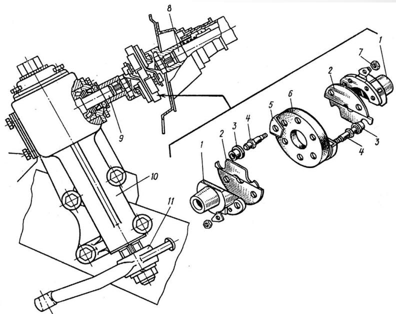
Нижний конец вала рулевого колеса может входить в рулевой механизм (ГАЗ-53-12 и др.) или соединяться с ним с помощью карданной передачи (автомобили КамАЗ, МАЗ, Москвич-2141, ГАЗ-3110 и др.) или с помощью энергопоглощающей муфты (ГАЗ-3102 и др.).
