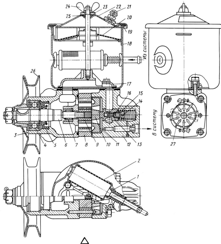
Сверху к корпусу насоса крепится бачок для масла, имеющий два фильтра 2 и 20, крышку 22 и сапун.
