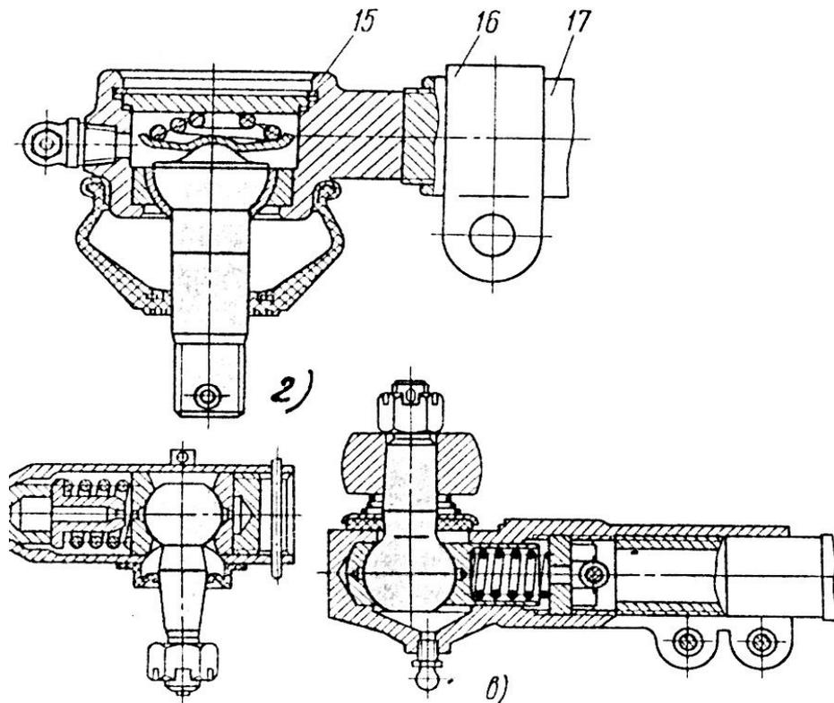
Сферической поверхностью колец 12 (рис. а) прижимается предварительно сжатой пружиной 3 через пята 2 к сменному вкладышу 14.
