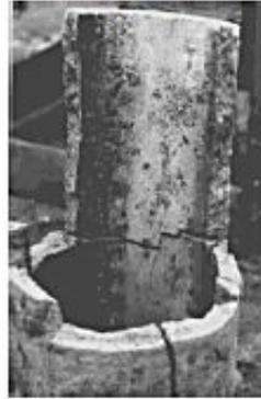
асбоцементная труба  $\varnothing 200 \times 18$  мм с дополнительной цементной оболочкой толщиной 25 мм
