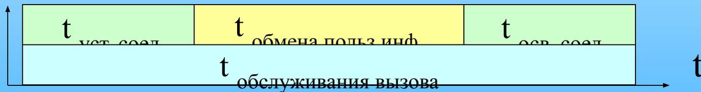
Обмен сигнальной информацией осуществляется только при установлении и освобождении соединения
