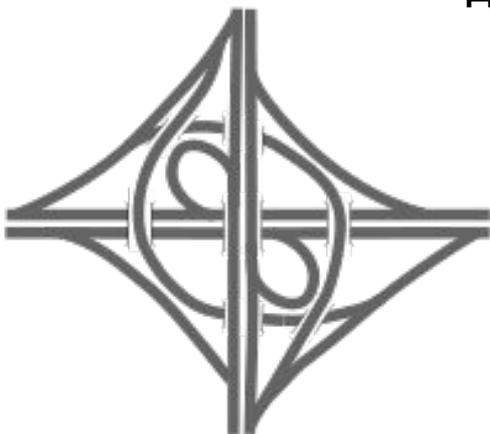
Данный вид развязки является естественной эволюцией классического клевера, когда вместо пары клеверных съездов, которые блокируются из-за проблемы съезжающих и заезжающих на развязку автомобилей при интенсивном движении (конфликт потоков) строятся отдельные съезды. При такой конструкции, двигаясь по любому из пересекающихся шоссе, сначала следует съезд транспорта с основного шоссе позволяющий съехать с шоссе всем желающим, и лишь затем следует заезд с пересекающегося шоссе
