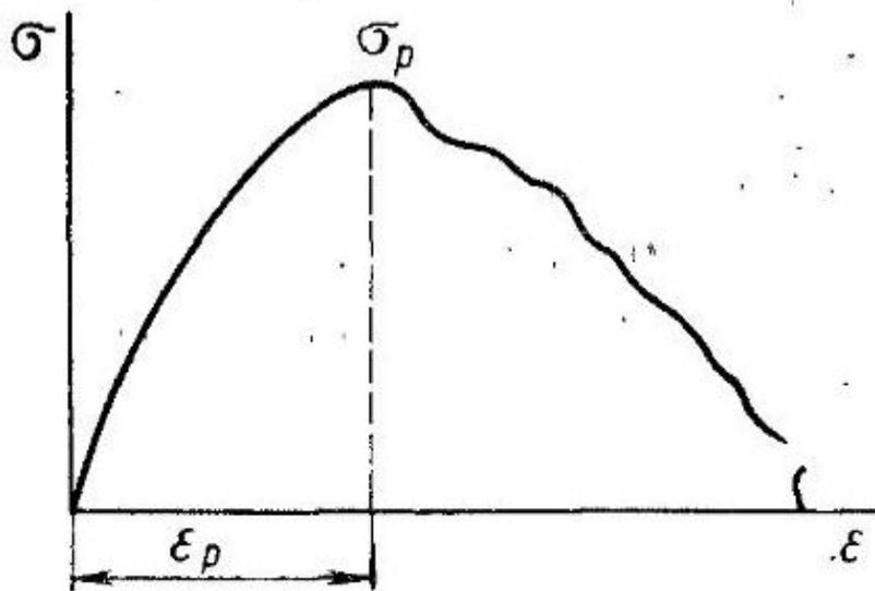
Рис. 13.6. Кривая напряжение — деформация для пластического материала
