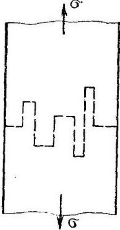
Рис. 13.7. Распространение трещины в высокоориентированном полимере
