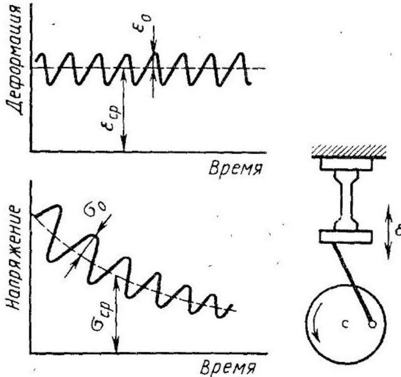
Рис. 13.12. Изменение амплитуды напряжения  $\sigma_0$  и среднего значения напряжения  $\sigma_{cp}$  в условиях многократных деформаций при заданном постоянном  $\epsilon_0$  и  $\epsilon_{cp}$ . Показана схема прибора для испытаний при  $\epsilon_0 = \text{const}$  и  $\epsilon_{cp} = \text{const}$
