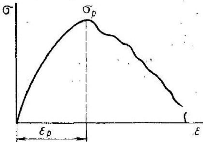
Рис. 13.6. Кривая напряжение — деформация для пластичного материала
