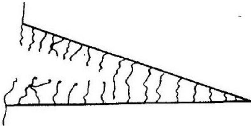
Рис. 13.3. Строение микротрещины, заполненной ориентированными сегментами полимера:
