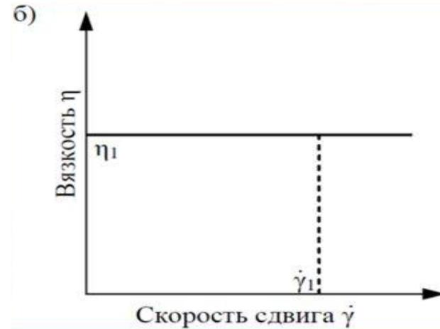
а – кривая течения ньютоновской жидкости; б – кривая вязкости ньютоновской жидкости
