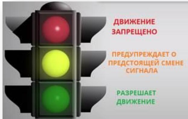
Светофор предназначен для регулировки движения транспортных средств и представляет собой светотехнический прибор, установленный в определенном месте с последовательным переключением световых сигналов определенных цветов.
