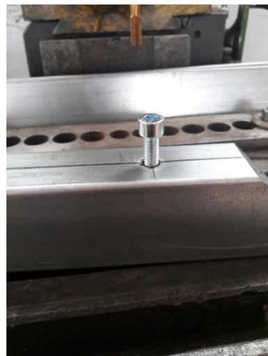
**Термосверление**, которое мы выполняем на нашем производстве - это прекрасная альтернатива заклепочным, приварным и запрессованным гайкам, при соединении тонкостенных элементов.
