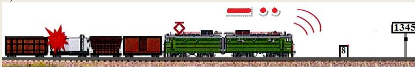
Категорически запрещается останавливать поезд с горящими вагонами, независимо от рода груза: на железнодорожных мостах, в тоннелях, под мостами, вблизи трансформаторных подстанций, тяговых подстанций, сгораемых строений или других местах, создающих угрозу быстрого распространения огня или препятствующих организации тушения пожара и эвакуации пассажиров.
