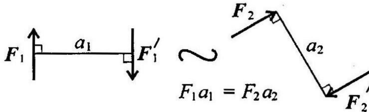
Сложение пар сил. Систему пар сил можно заменить равнодействующей парой. Момент равнодействующей пары равен алгебраической сумме моментов пар, составляющих систему
