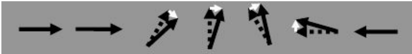
Рис. Иллюстрация индуцированного током движения доменной стенки, обусловленного механизмом переноса спина. Неравновесная поперечная компонента поляризации носителей (белые стрелки) передается магнитным моментам внутри доменной стенки (черные стрелки); это приводит к движению последней.
