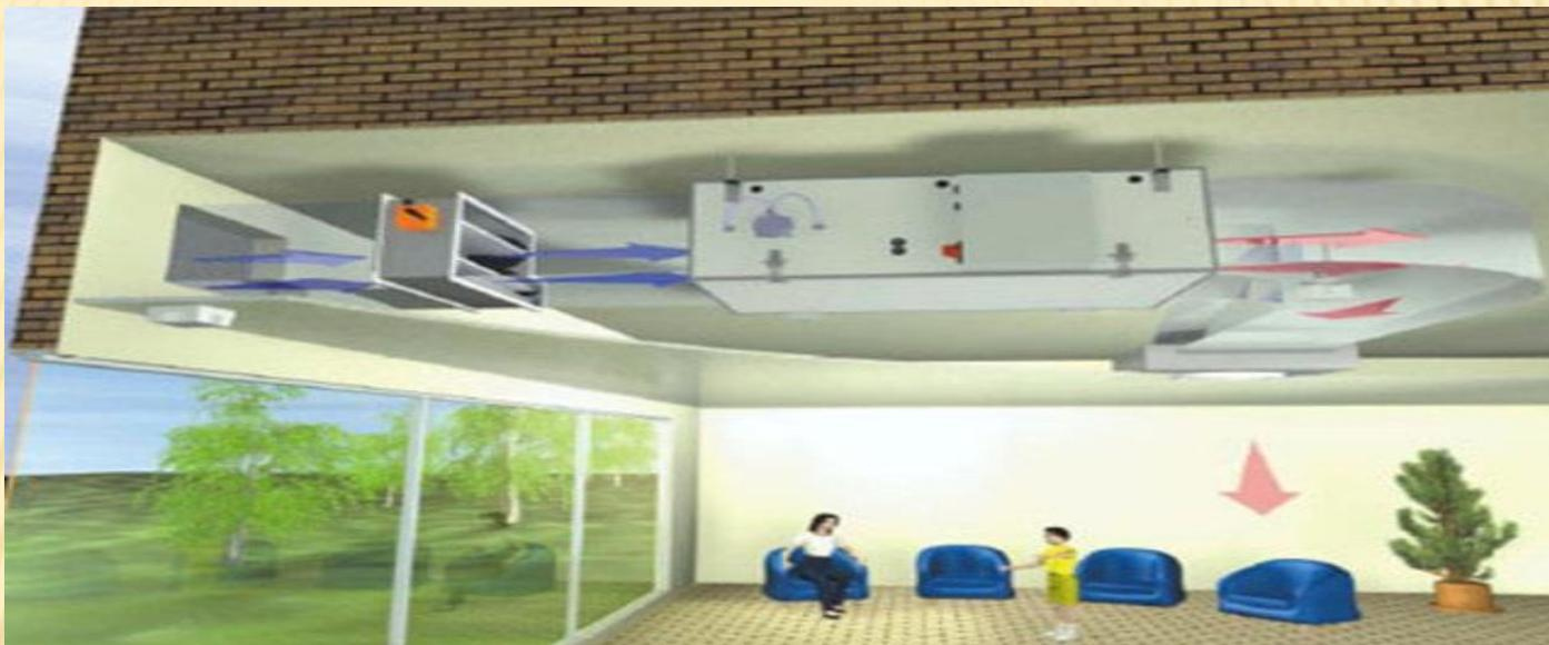
автоматически поддерживает заданные оптимальные параметры воздушной среды: температуру, относительную влажность, скорость движения (подвижности) и чистоту воздуха.
