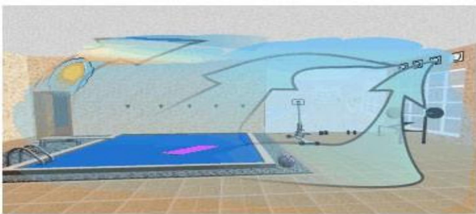
В плавательных бассейнах рекомендовано применять воздушное отопление, что позволяет одновременно снизить относительную влажность воздуха в зале.
