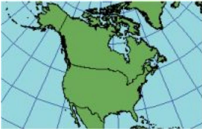
В этой проекции меридианы представляют собой расположенные через одинаковые интервалы прямые линии, сходящиеся в одной точке. Полюса представлены скорее как дуги, чем как отдельные точки. Параллели выглядят как концентрические окружности, разнесенные на разные расстояния; интервал между ними уменьшается по направлению к полюсам.
