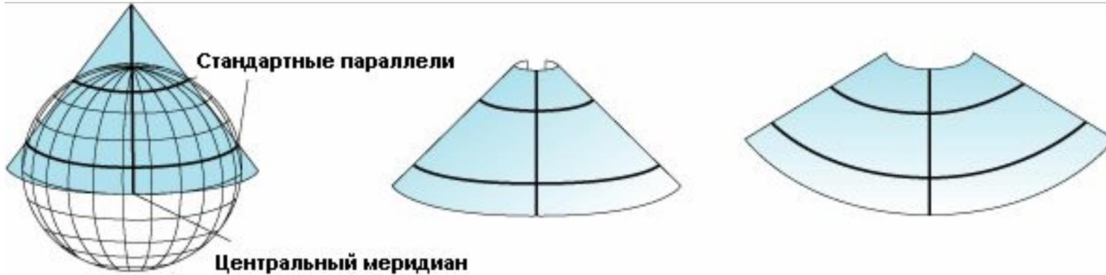
Конус размещается на земном шаре. Конус и земной шар касаются друг друга по линии широты. Она называется стандартной параллелью. Конус "разрезается" по линии долготы, противоположной центральному меридиану, и разворачивается на плоскость
