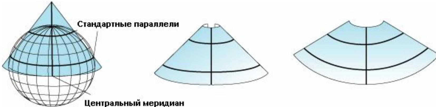
Конус так же оборачивается вокруг земного шара, но проходит сквозь поверхность. Поэтому конус и земной шар имеют две общие линии широты. Это линии стандартных параллелей. Конус "разрезается" по линии долготы, противоположной центральному меридиану, и разворачивается на плоскость
