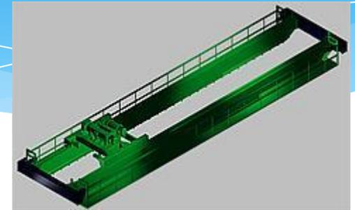
Несущие элементы мостового крана опираются непосредственно на крановый путь. Мост (несущая балка) перемещается по рельсам, уложенным на стенах зданий или на эстакадах вне здания.
