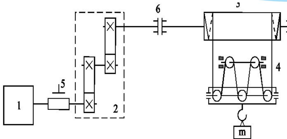
1 – асинхронный двигатель; 2 – редуктор; 3 – барабан; 4 – силовой полиспаст; 5 – тормозной механизм; 6 – устройство для соединения(муфта).
