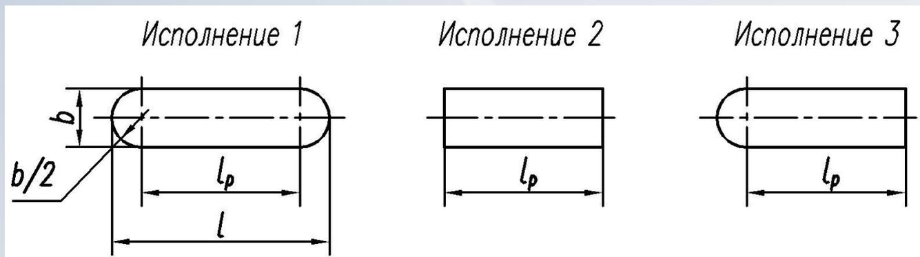
Рабочая длина шпонки  $l_p$ , определяющая нагрузочную способность соединения, не учитывает закругленные участки шпонки. Так, для шпонки исполнения 1 запишем  $l_p = l - b$ , для шпонки исполнения 2 имеем  $l_p = l$ .
