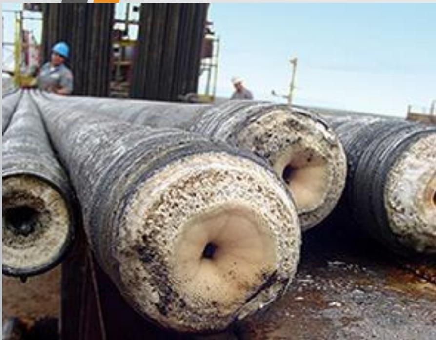
Процесс застывания начинается у стенок трубы и постепенно распространяется к центру.
