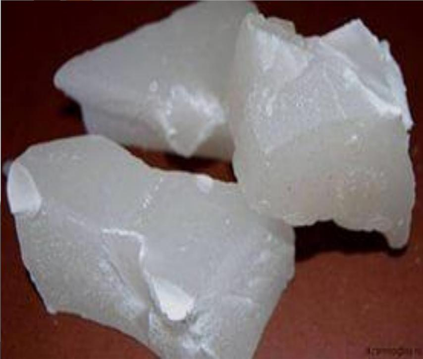
Парафин выделяется из нефти в виде кристаллов, которые, соединяясь между собой, образуют парафиновую массу. Она представляет собой пористый скелет, поры которого заполнены нефтью и водой. Температура плавления такой массы зависит от ее состава и колеблется от 40 до 50° С. Вязкость застывания парафинистой нефти зависит от количества находящегося в ней парафина и температуры. Чем больше содержание парафина и ниже температура нефти, тем больше увеличивается ее вязкость и тем меньше ее тягучесть.
