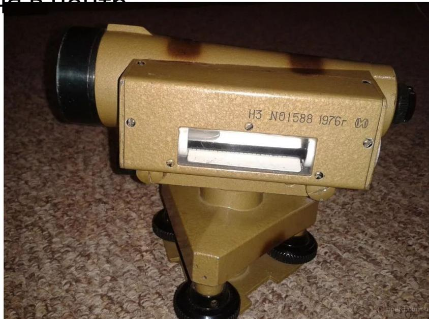
2. Вертикальная нить сетки должна быть параллельна оси вращения прибора.
