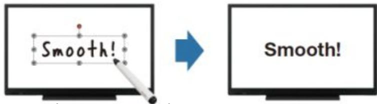
\*Преобразование выбранного почерка на экране в печатный текст. Распознавание только горизонтального текста
