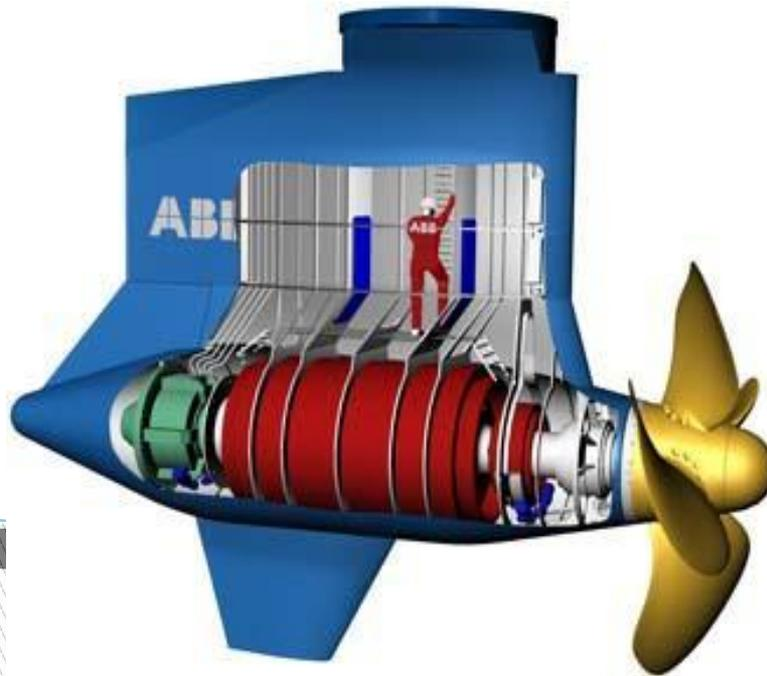
**Схема устройства азимутальной
