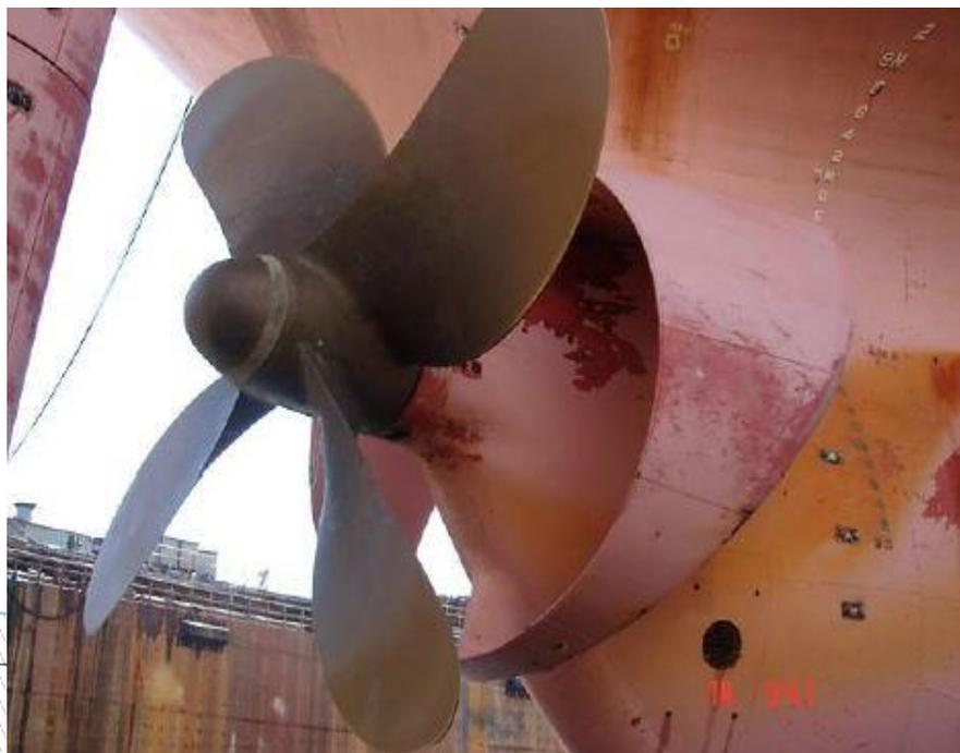
**Рис. а. Гребной винт фиксированного шага (ВФШ)**
