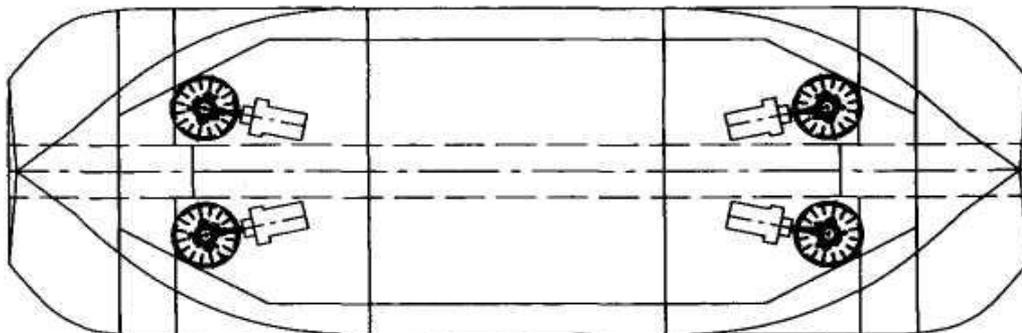
Компоновка водометов с центробежными насосами на пароме
