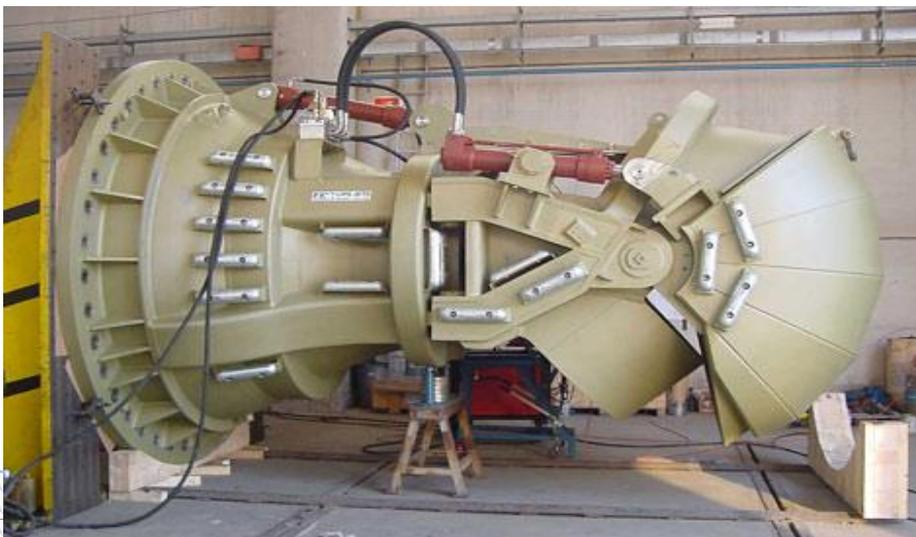
**Рис.а Водомет с осевым насосом фирмы HYFLO**
