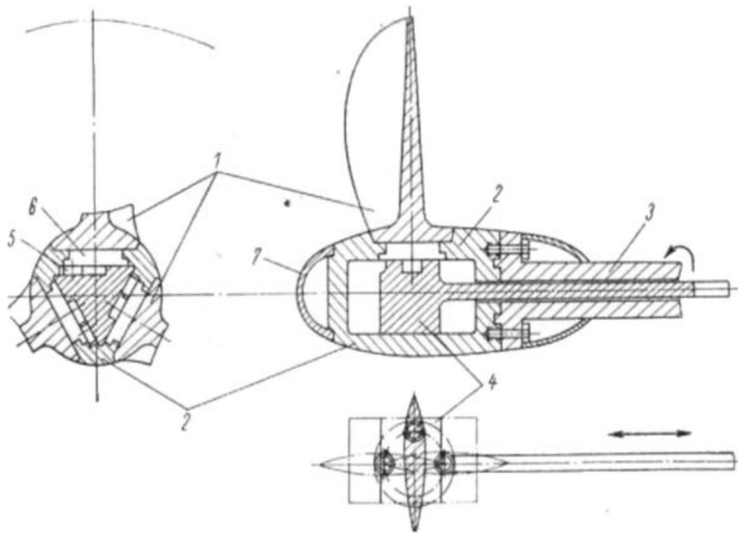
**Гребной винт регулируемого шага**
