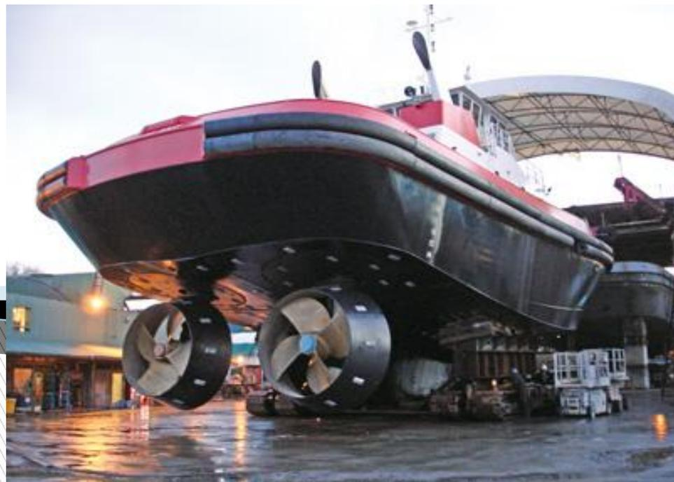
Большой интерес представляют винто-рулевые колонки, когда гребные винты приводятся в движение электродвигателем, размещенным непосредственно в гондоле колонки. Движители этого типа с одним винтом разработали фирмы Kvaerner Masa-Yards в сотрудничестве с АВВ (Финляндия, патентованное название Azipod).
