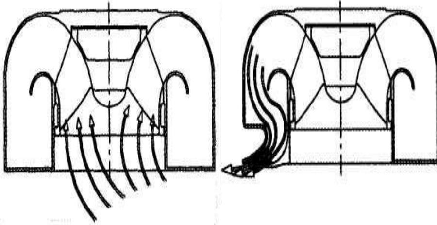
Принцип действия водомета с горизонтально расположенным центробежным насосом
