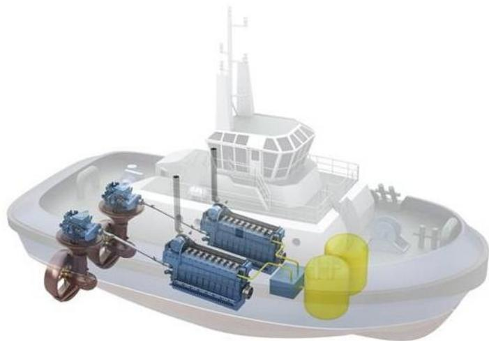
**Схема размещения винто-рулевых колонок на буксире**
