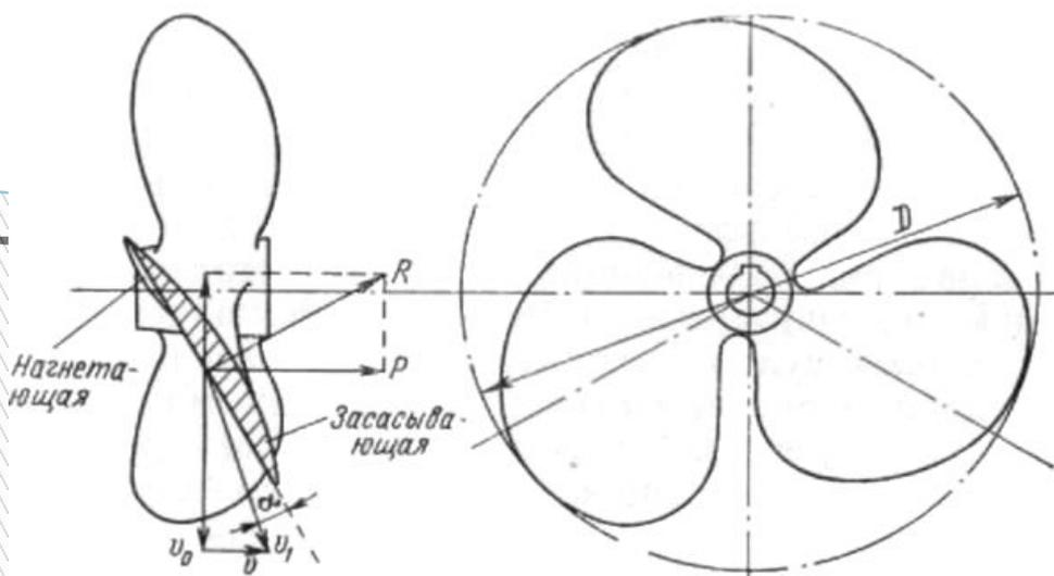
Реакция этой воды воспринимается нагнетающей поверхностью лопасти, создающей упор винта, который через ступицу и гребной вал передается на упорный подшипник, преобразуясь в силу, движущую судно.
