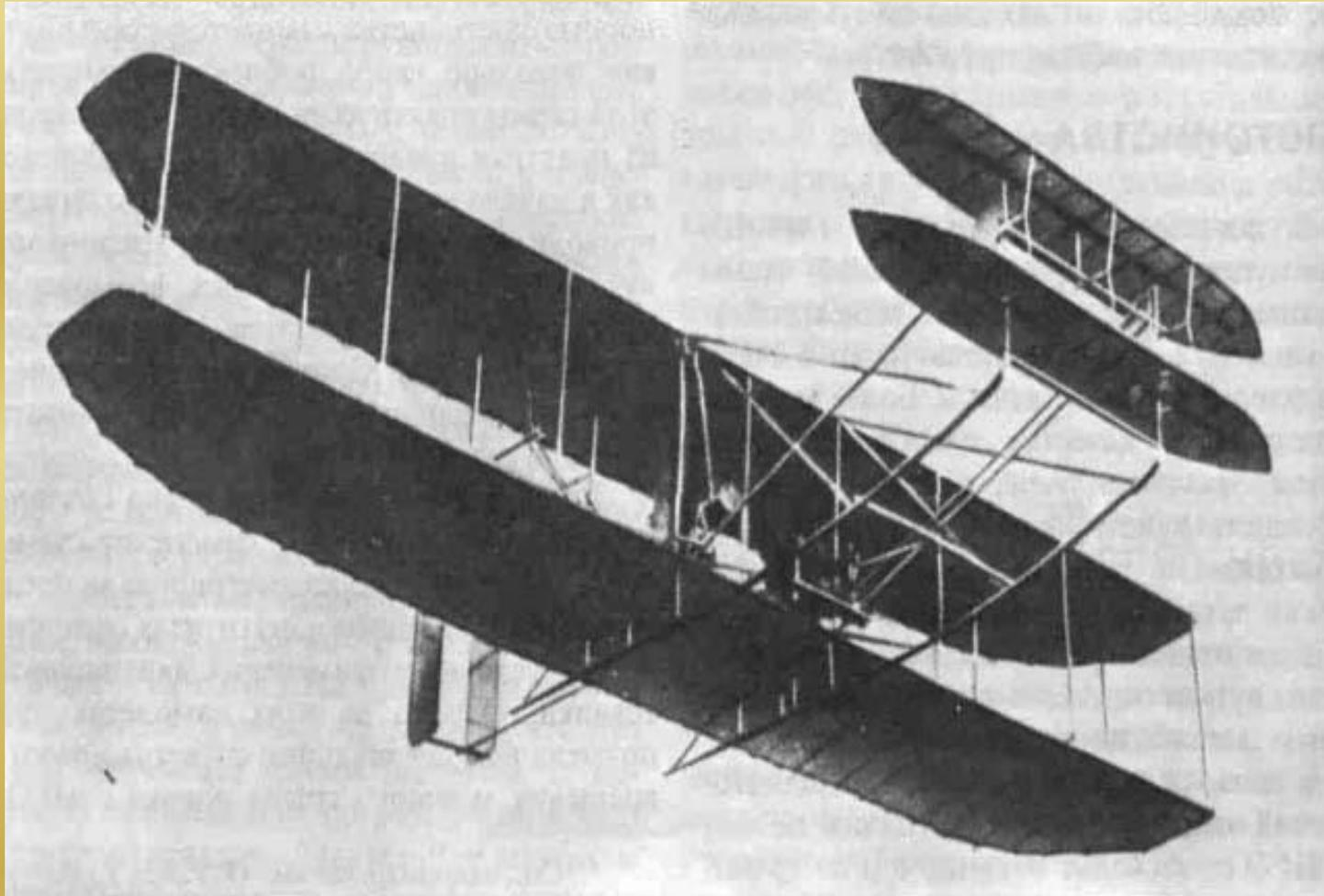
Аэроплан «**Флайер**» – первый самолет братьев Райт, во время испытания в 1903 г. пролетел 36 м, полет продолжался 12 с
