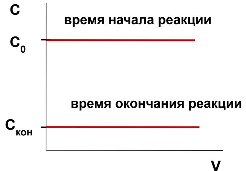
**В реакторе РИС-П не происходит перемешивание реагентов за счёт конвективной диффузии, тогда первая и вторая производные в уравнении материального баланса равны 0:**
