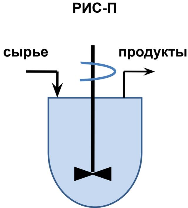
РИС-П – это аппарат с мешалкой, в который загружают реагенты, после достижения заданной степени превращения продукт выгружают. Изменение концентрации реагента  $A$  происходит за счёт протекания хим. реакции.
