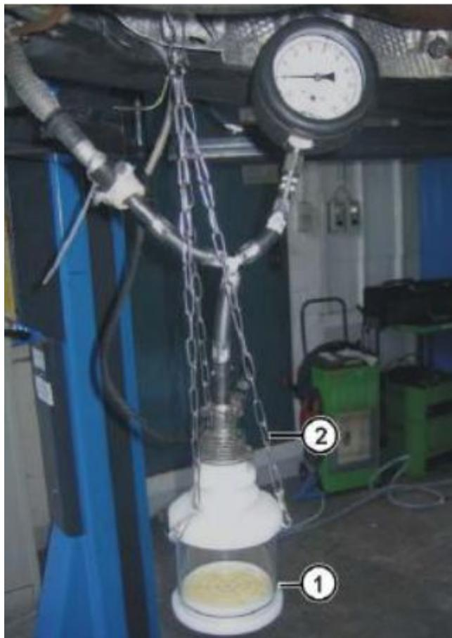
Используя индикаторную бумагу и диагностическое устройство, проверьте факел распыления.
