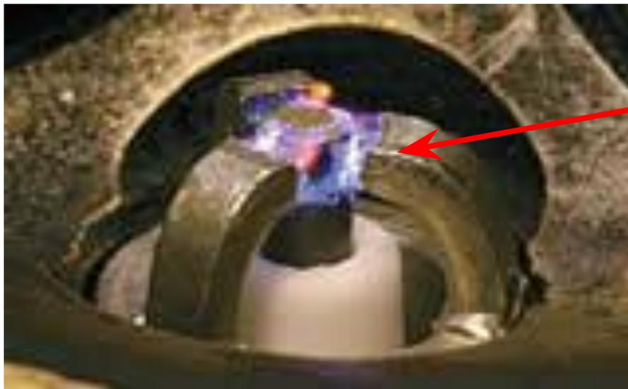
Образование искрового разряда в камере сгорания ДВС
