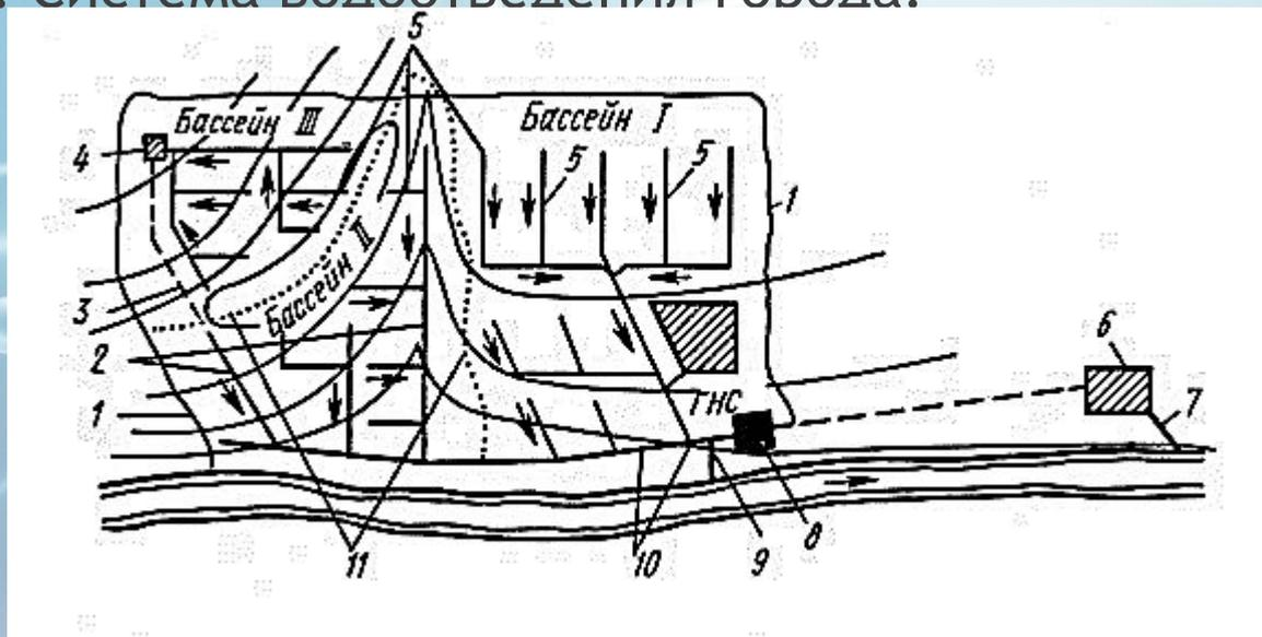
\* 1 - граница города; 2 - коллекторы; 3 - напорный трубопровод; 4 - насосная станция; 5 - уличная сеть; 6 - очистные сооружения; 7 - выпуск в водоем; 8 - главная насосная станция; 9 - аварийный выпуск; 10 - главный коллектор; 11 - границы бассейнов канализования.
