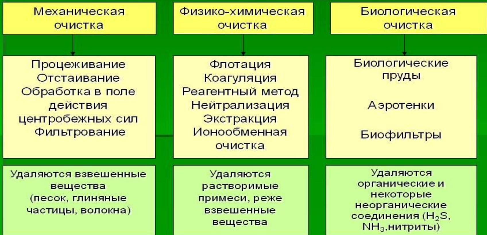
\* Для улучшения параметров очистки могут быть применены различные химические методы, как, например, дополнительная седиментация ( оседание частиц дисперсной фазы в жидкости или газе под действием гравитационного поля или центробежных сил ) фосфора солями Fe и Al, хлорирование, озонирование, а также физико-химические методы, такие как электрофлотация ( Метод основан на проведении электролиза воды на нерастворимых электродах и флотационном эффекте.
