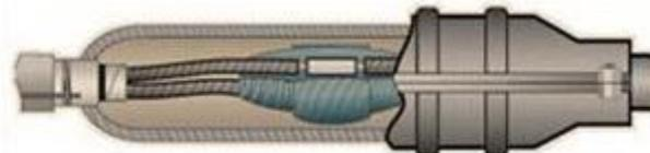
Концевые муфты (заделки) служат для предохранения изоляции кабеля от проникновения в нее влаги, содержащейся в окружающем воздухе и его присоединения к электрооборудованию или ЛЭП. Муфта, предназначенная для присоединения кабельной линии к воздушной, называется мачтовой муфтой (КМ), она устанавливается на опорах.
